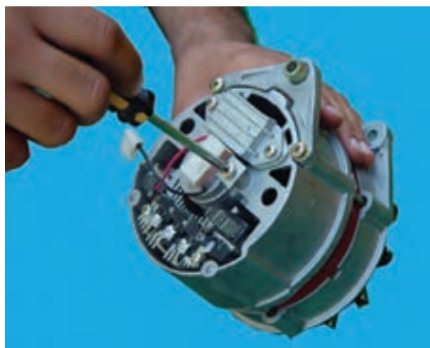
شکل ۷-۵۳- بازکردن پارازیت گیر
