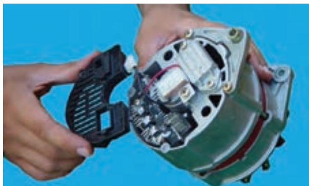
شکل ۷-۵۲- بازکردن درپوش دیودها
