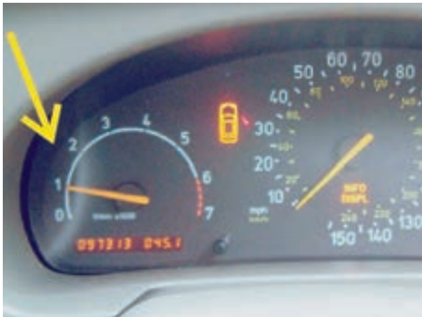
شکل ۷-۱۰۰- حالت دور آرام موتور
