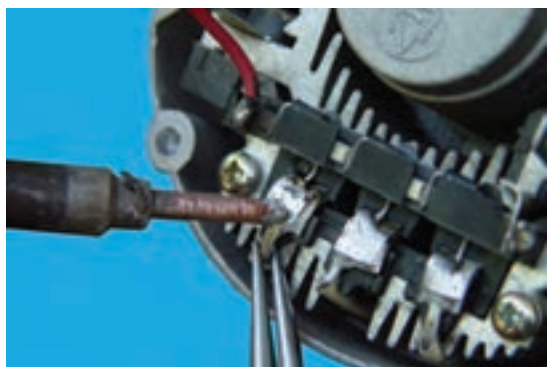
شکل ۵۶-۷- جدا کردن سیم‌های استاتور از یک‌سوکننده
