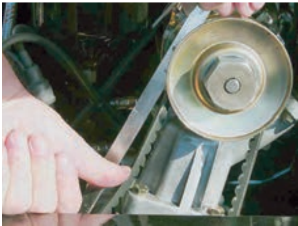
شکل ۷-۸۹- اندازه گیری خلاصی تسمه پروانه
