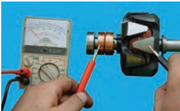
شکل ۷۴-۷- آزمایش اتصال بدنه نبودن سیم پیچ روتور
