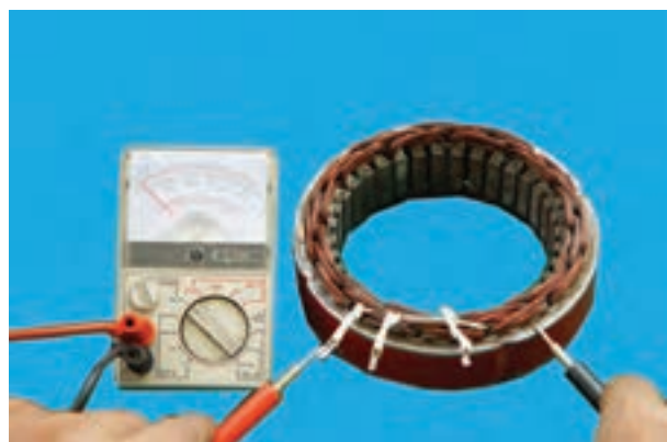
شکل ۷-۷۸ - آزمایش اتصال بدنه نبودن سیم پیچ استاتور
