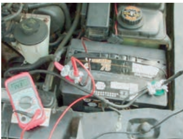
شکل ۷-۱۰۲- اندازه‌گیری ولتاژ شارژ
