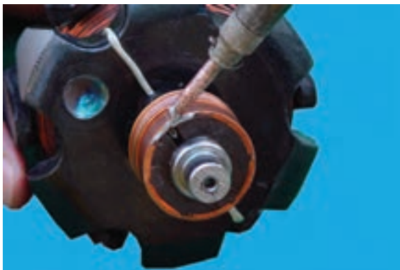
شکل ۶۶-۷ – جدا کردن سیم‌های روتور از کلکتور
