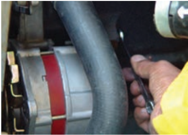
الف - بازکردن پیچ‌های پایه‌ی آلترناتور
