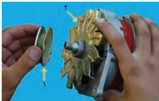
۱- پولی ۲- واشر فاصله برکن شکل ۵۸- ۷- جدا کردن پولی آلترناتور
