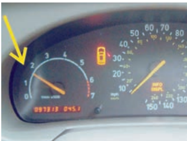
شکل ۷-۱۰۱- افزایش دور موتور برای آزمایش
