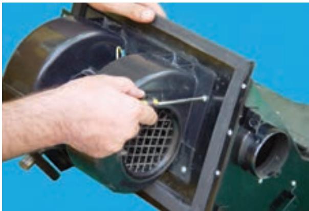
شکل ۳۶-۴- باز کردن پیچ‌های محفظه‌ی موتور
