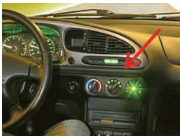
شکل ۴-۵۳- روشنایی سوئیچ نصب شده در پانل جلوی راننده
