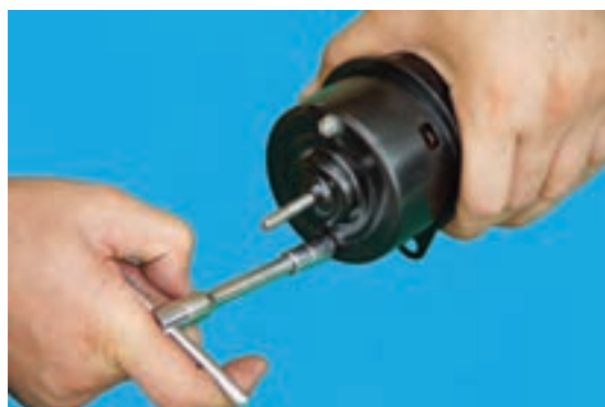
شکل ۴-۴۴- باز کردن پیچ‌های پوسته‌ی موتور
