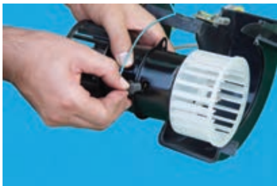
شکل ۴-۴۱- جدا کردن سیم از زغال‌ها
