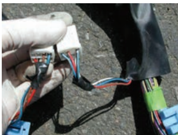
شکل ۲۳-۳- مقایسه و تطبیق سوکت‌های کلاف سیم‌کشی
