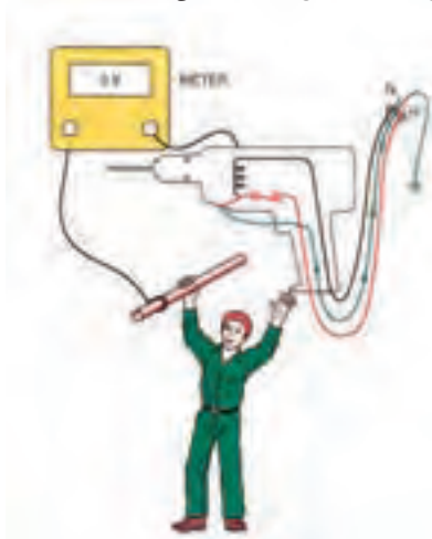
شکل ۴-۲۶ دستگاه دریل دارای سیم ارت
