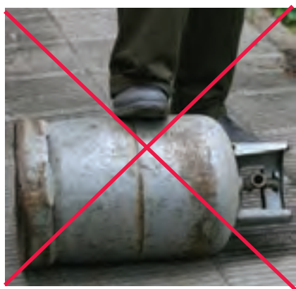
شکل ۶۹-۱ حمل و نقل نادرست کپسول گاز مایع
