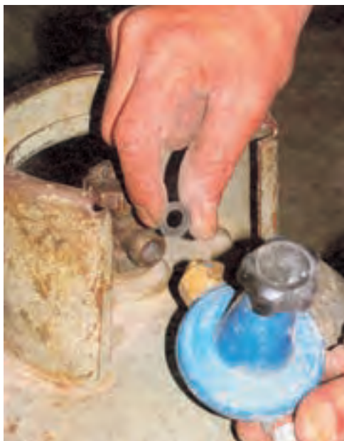
شکل ۱-۶۲ ب رگولاتور قابل تنظیم
