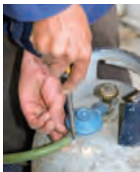
شکل ۱-۶۶ ب سفت کردن بست
