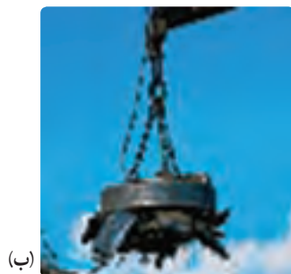
شکل ۳-۲۱ (الف) سیملوله با هسته آهنی. (ب) آهنربای الکتریکی صنعتی
