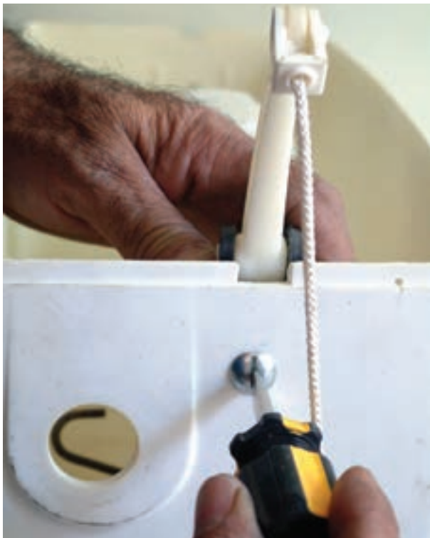
شکل ۳-۲۰۹- اتصال اهرم به بدنه‌ی مخزن فشاری
