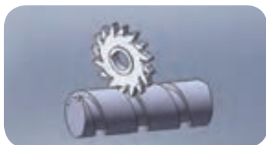
موقعیت قرارگیری تیغه فرز نسبت به قطعه کار برای فرزکاری شیار مارپیچ
