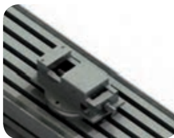
بستن گیره بر روی میز ماشین به طور صحیح
