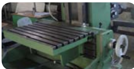
میز ماشین فرز و سیستم حرکتی آن
