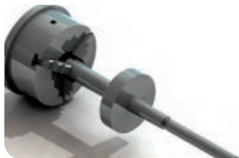
سوار کردن درن بر روی دستگاه تقسیم
