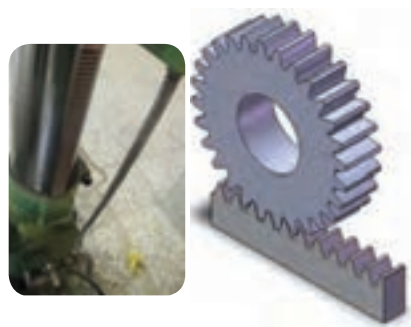
کاربرد چرخ و شانه در ماشین‌های مته
