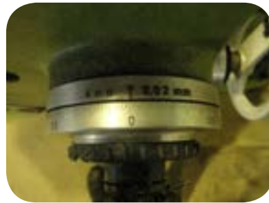
صفر کردن ورنیه دستگاه
