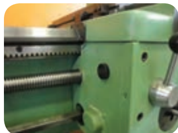
کاربرد چرخ و شانه در ماشین‌های تراش
