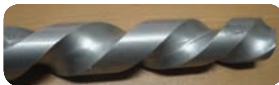
ایجاد شیار مارپیچ در یک میله گرد
