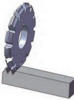
تراشیدن دنده شانه‌ای بوسیله ماشین فرز افقی و عمودی
