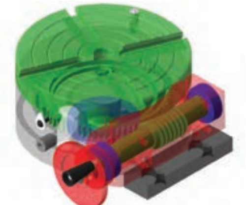
نمایش سیستم داخلی میزگردان
