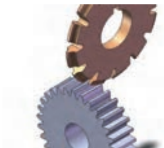
نمایش تیغه فرز مدولی و قطعه کار
