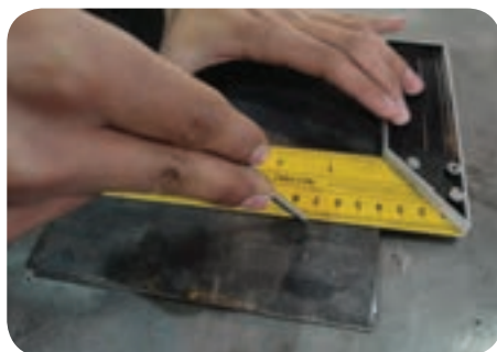
رعایت زاوایی تمایل سوزن خط‌کش
