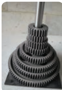
سری چرخ‌دنده تعویضی استاندارد
