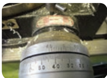
حلقه مدرج دستگیره میزگردان برای جابجایی دقیق‌تر
