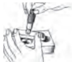
کنترل عمق سوراخ با استفاده از میکرومتر
