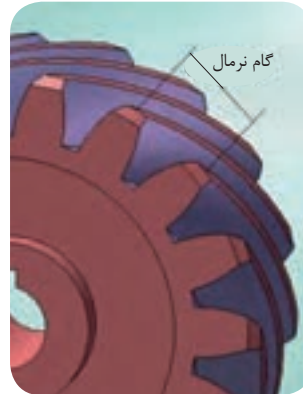
نمایشی گام نرمال در چرخ‌دنده مارپیچ
