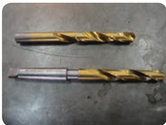
دنباله استوانه‌ای و مخروطی در مته‌ها
