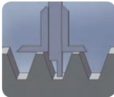
نحوه استفاده از کولیس عمق سنج
