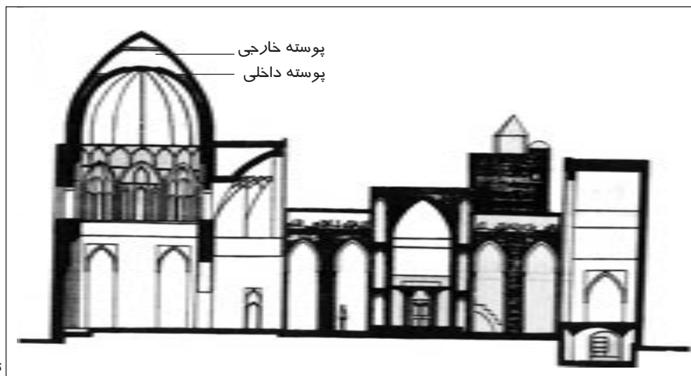
تصویر ۵-۲۰- سقف دو پوسته در گنبد
