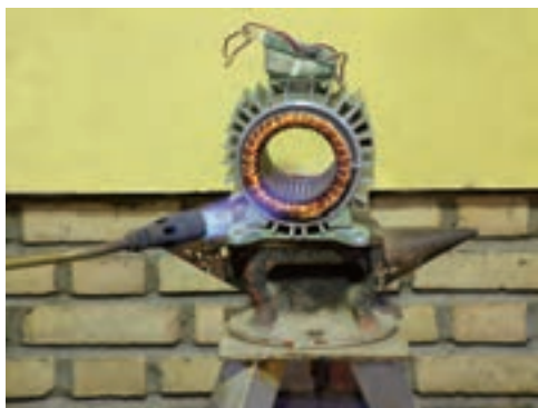
شکل ۲-۱۸- سوزاندن مستقیم سیم‌ها با شعله
