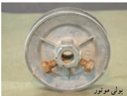
شکل ۱-۲۵- باز کردن پولی موتور
