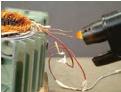
شکل ۴-۱-ب - پاک کردن لاک به روش سوزاندن
