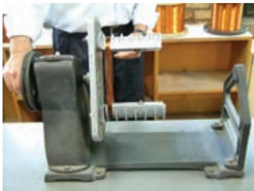
شکل ۱۷-۳ - بیچیدن سیم‌ها روی قالب‌ها
