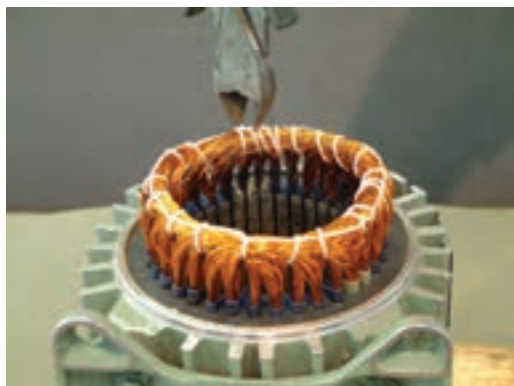
شکل ۲-۱۳ - چیدن نخ‌های کلاف‌بندی با سیم‌چین
