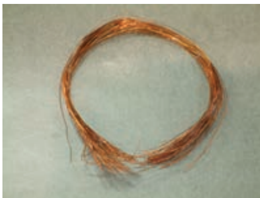
شکل ۱۶-۳- الف - شمارش تعداد دور هر بوبین
