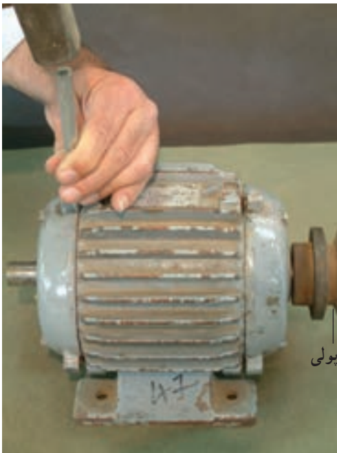
شکل ۱۰-۱- استفاده از چکش فلزی برای علامت گذاری در باز کردن قطعات موتور
