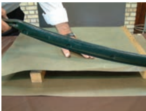
شکل ۲۹-۲ - کاتر یا دستگاه برش‌دهنده‌ی عایق‌های برشمان
