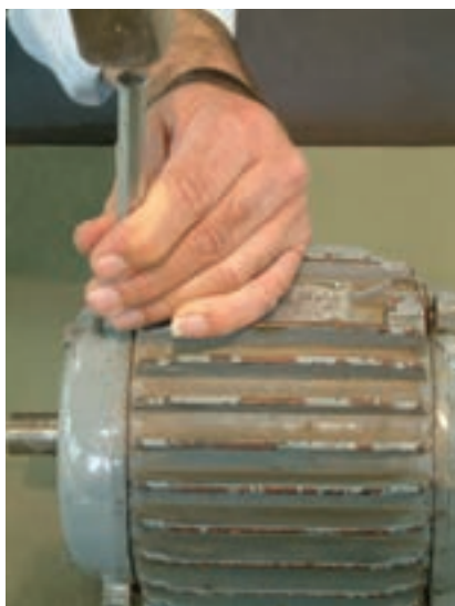
شکل ۱-۲۳- علامت گذاری روی پوسته و درپوش‌ها
