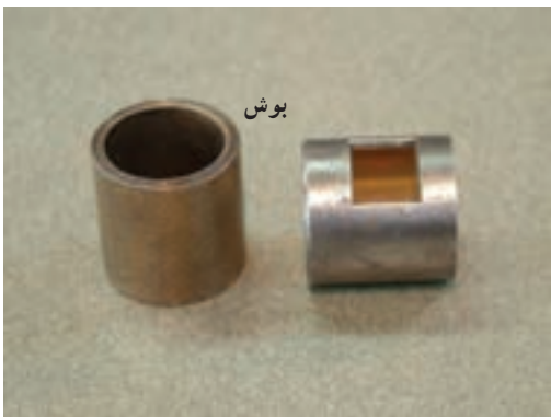
شکل ۳۸-۱- یاتاقان (بوش و کاسه نمد)
