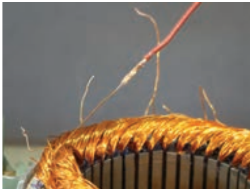
شکل ۴-۱۱- اتصال سیم‌های افشان به سیم‌های لاک‌ی
