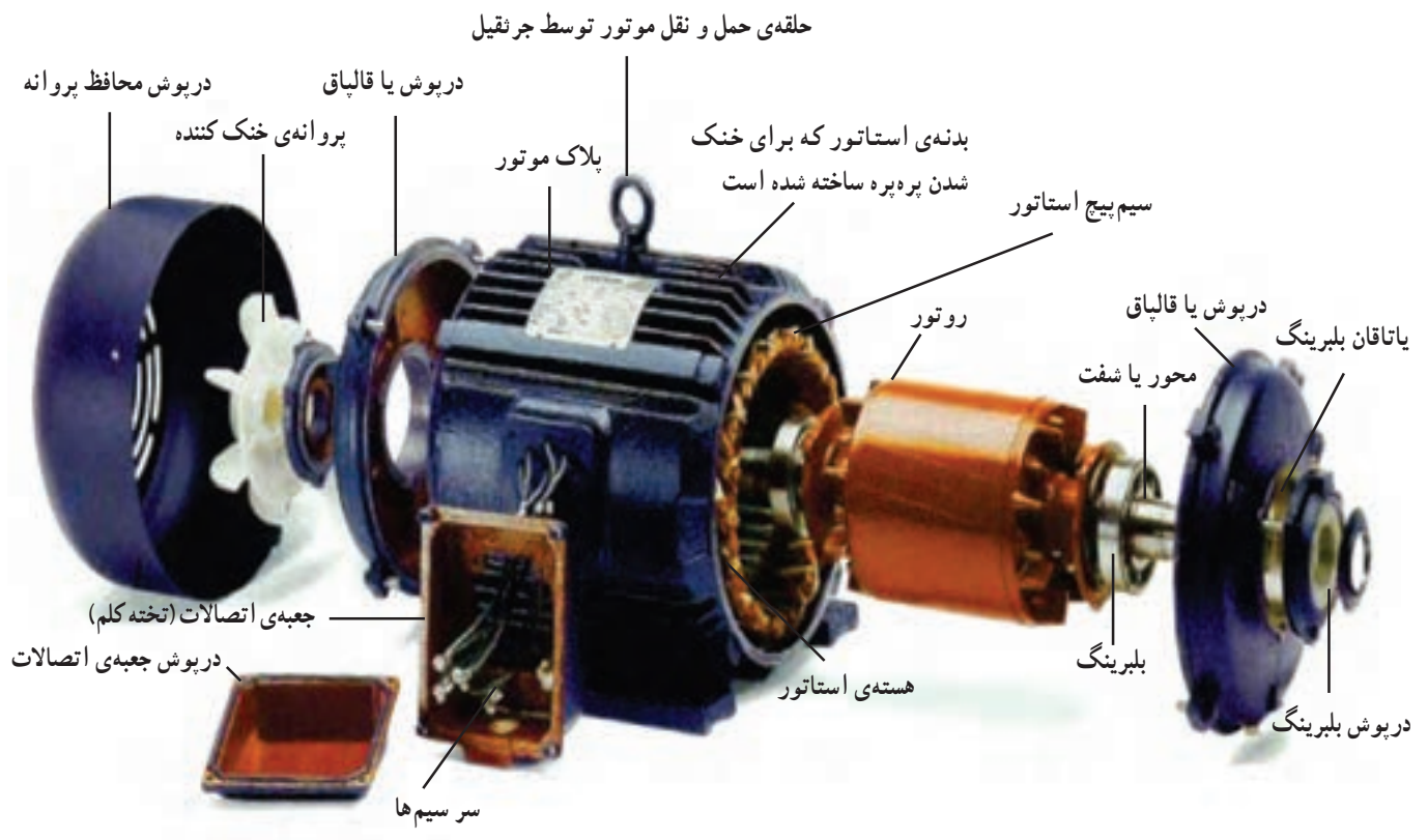
شکل ۱-۳- اجزای اصلی موتور سه فاز
