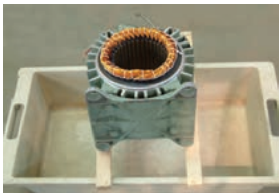
شکل ۲۴-۴ – قرار دادن استاتور روی وان
