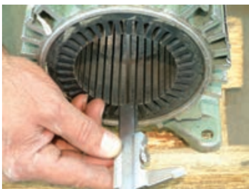
شکل ۲-۳۲- اندازه‌گیری طول شیار
