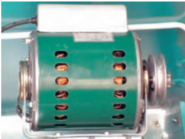
شکل ۱-۲۸- موتور تک فاز با راه انداز خازنی
