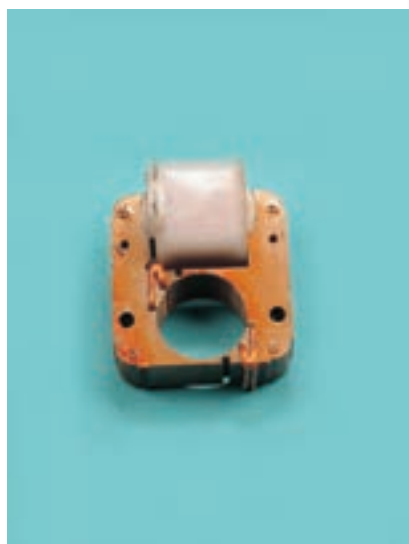
شکل ۲-۲- استاتور موتور قطب چاکدار
