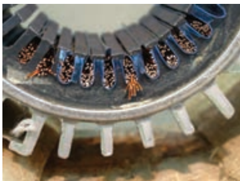
شکل ۲-۲۱ - برش سیم‌ها در یک طرف استاتور
