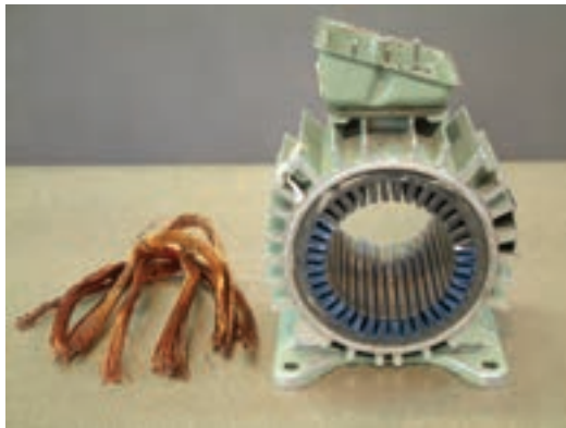
شکل ۲۴-۲- سیم‌های بیرون آمده از استاتور
