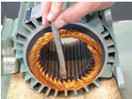
الف- قرار دادن قلم روی سیم‌ها
