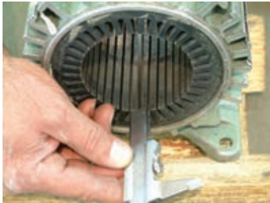
شکل ۲۶-۲- اندازه گیری محیط داخلی و طول شیار
