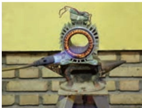
شکل ۲-۱۸- سوزاندن مستقیم سیم‌ها با شعله
