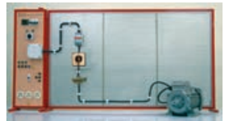
شکل ۱-۱۳۷- نمای قطعات نصب شده به همراه کابل و موتور متصل شده
