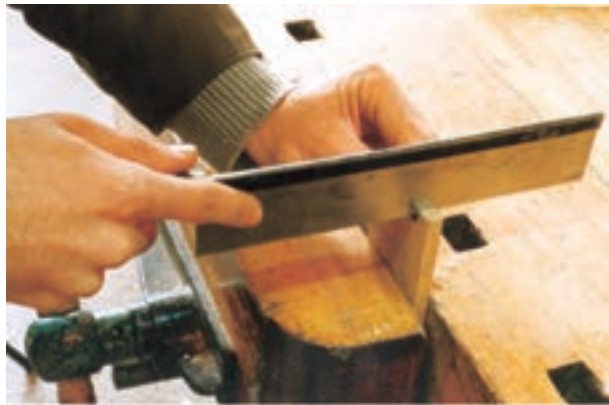
شکل ۹-۶۵- برش فاق و زبانه‌ها با اره‌ی ظریف‌بر (پشت‌دار).
