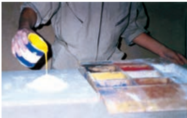
شکل ۴-۳- مواد تشکیل دهنده‌ی بتونه (روغنی).
