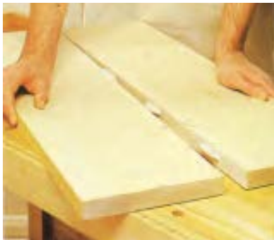
شکل ۹-۹۴ - صفحه‌ی رویه، با اتصال بیسکویتی.
