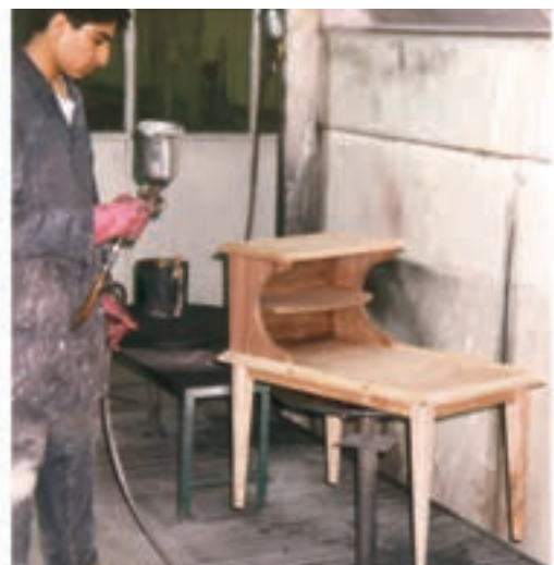
شکل ۲۴-۴. رنگ‌کاری با پیستوله (رنگ شفاف).
