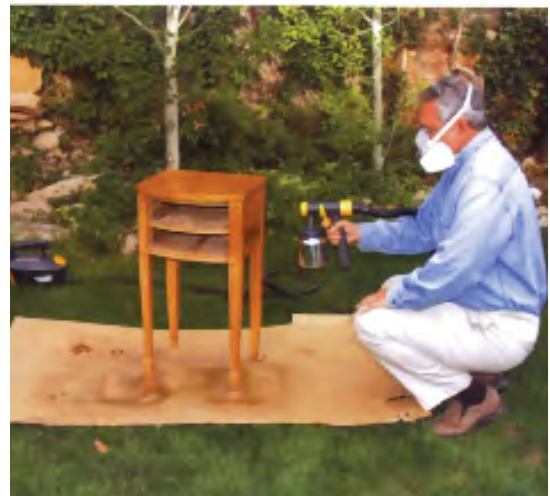
شکل ۲۳-۴. رنگ‌کاری با پیستوله (رنگ پوششی).
