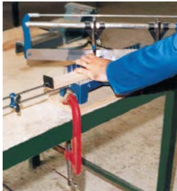
شکل ۱۴-۸. ایجاد برش ۴۵ درجه در گوشه‌های قیده‌های قاب، به وسیله اره فارسی بر دستی.
