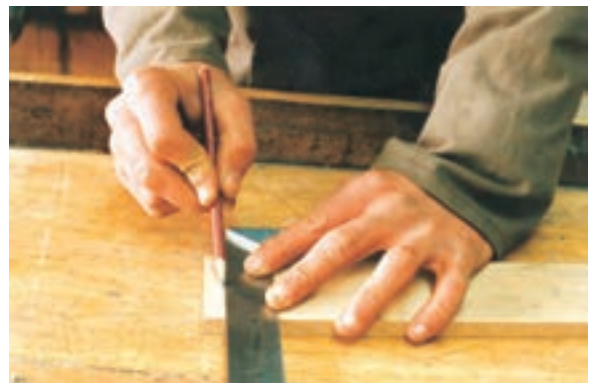
شکل ۹-۶۳- فم کشی ممل اتصال با گونیا.
