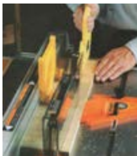
شکل ۱۲-۳- استفاده از وسایل کمکی در هنگام کار.
