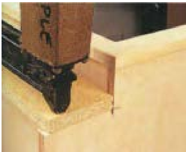
شکل ۸-۲۰- اتصال تخته خرده چوب به کابینت.
