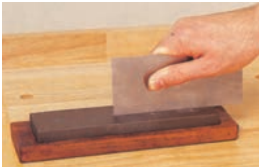
شکل ۸-۲- نمونه‌ی قرار دادن ضخامت لیسه روی سنگ نفت.
