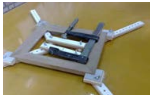
شکل ۹-۷۴ - نمای کلی گیره‌ی چوبی، که یک قاب عکس را در فود جای داده و محکم گرفته است.
