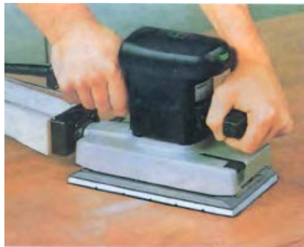
شکل ۳-۱۴- سنباده‌زنی با یک دستگاه سنباده لرزان کامل.
