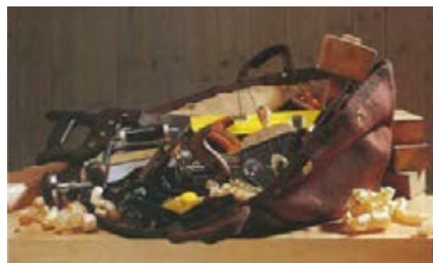
شکل ۲-۱۶- ریفتن ابزارها (روی هم، علاوه بر کاهش تیزی، از دقت آنها نیز می‌کاهد.
