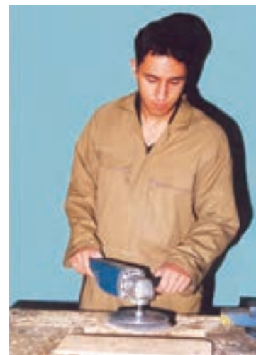
شکل ۷-۴۰- هدایت و کنترل صمغ دستگاه سنباده.
