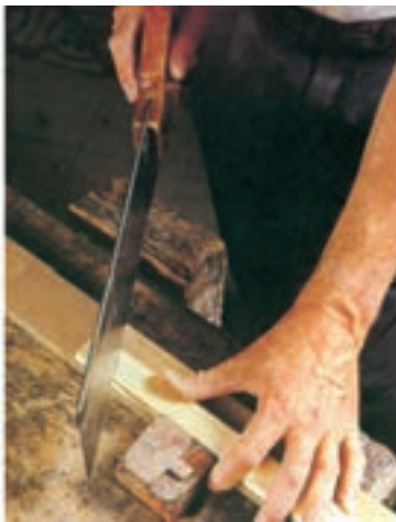
شکل ۱۱-۱۰- برش زهوار، با زاویه‌ی ۴۵ درجه.
