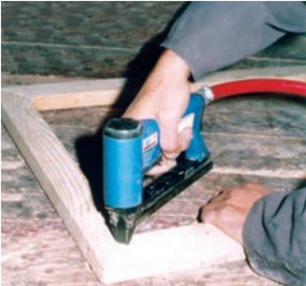
شکل ۱۶-۸. منگنه زدن روی درزهای ۴۵ درجه شده.
