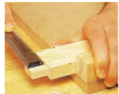
شکل ۹۹۸- اندازه کردن زبانه با مغار.
