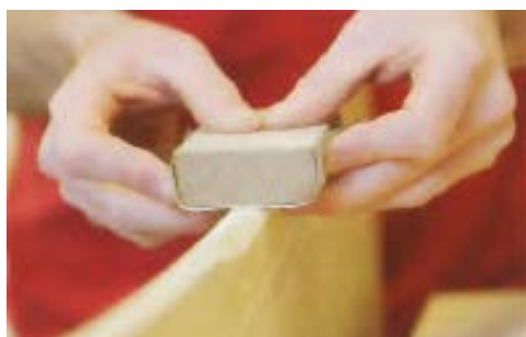
شکل ۳-۲۱. طریقه‌ی سنباده‌کاری نر قطعات با دو دست.
