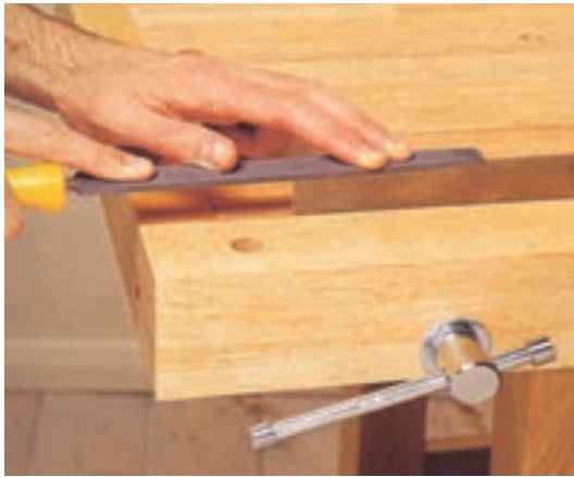
شکل ۷-۲- نمونه‌ی سوهان زدن ضخامت لیسه.
