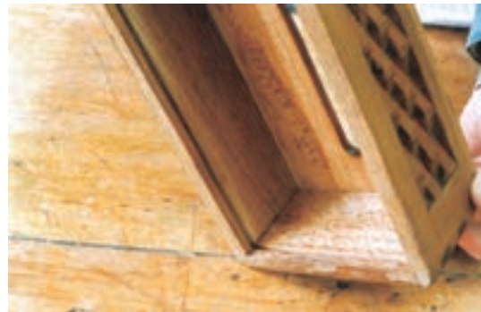
شکل ۹-۶۷- کنشکاف داخل بدنه‌های یک جعبه دستمال کاغذی.
