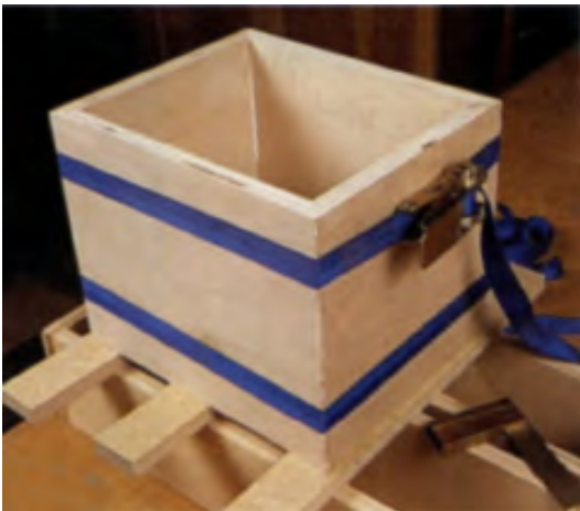
شکل ۱۴۸- از گیره‌ی تسمه‌ای می‌توان برای پسباندن بدنه‌های صندوق مکعبی نیز استفاده کرد. با توجه به ارتفاع آن، می‌توان ۲ تسمه یا بیشتر به‌کار برد.
