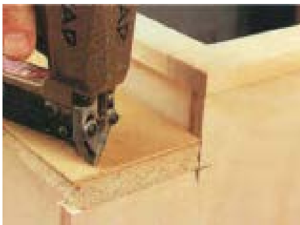
شکل ۸-۲۱- اتصال سه‌لایی به تخته خرده چوب.
