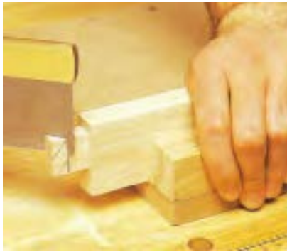
شکل ۹۹۹- به اندازه (ساختن زبانه با اره‌ی ظریف‌بُر (پشت‌دار)).
