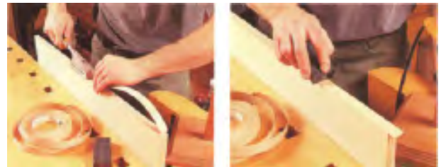
شکل ۱۴۴- برای پسباندن لب‌پسبان‌هایی از جنس روکش طبیعی یا مصنوعی، می‌توان از اتو استفاده کرد.
