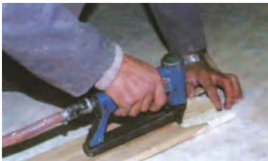
شکل ۴-۸- کاربرد منگنه‌زن در اتصال دو قطعه چوب به هم.
