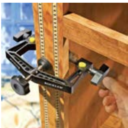
شکل ۱۴۰- برای چسباندن زهوار، باید از گیره‌های مخصوص لبه چسبانی استفاده کرد.
