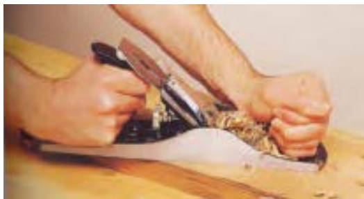
شکل ۲-۱۸- رنده در جهت الیاف، ولی اندکی کج هدایت شود.
