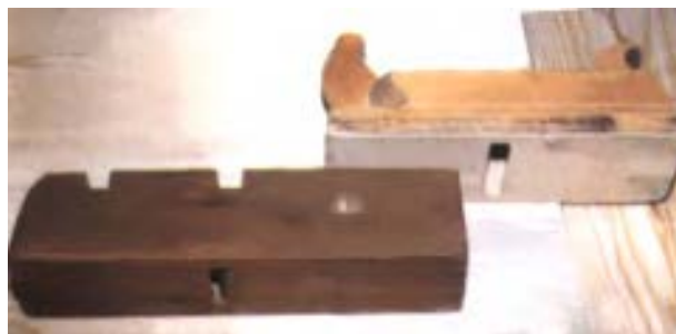
شکل ۲-۱۷- پس از پایان کار، رنده‌ها به پهلو فوابانده شود.
