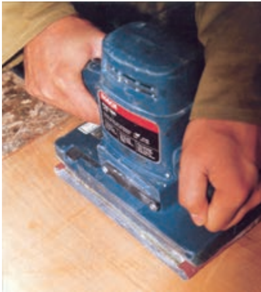
شکل ۷-۱۱. سنباده کاری در جهت الیاف.
