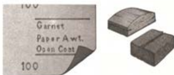
شکل ۷-۲۴- ورق سنباده استاندارد.
