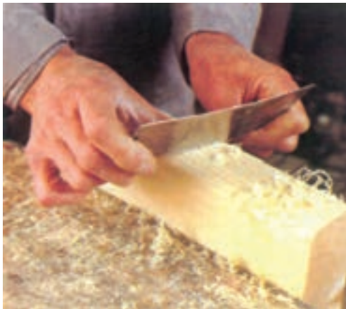
شکل ۲۹- برای لیسسه کاری، لیسسه را کمی خم کرده روی سطح چوب هدایت کنید.
