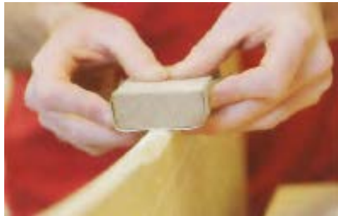
شکل ۳-۲۱. طریقه‌ی سنباده‌کاری نر قطعات با دو دست.
