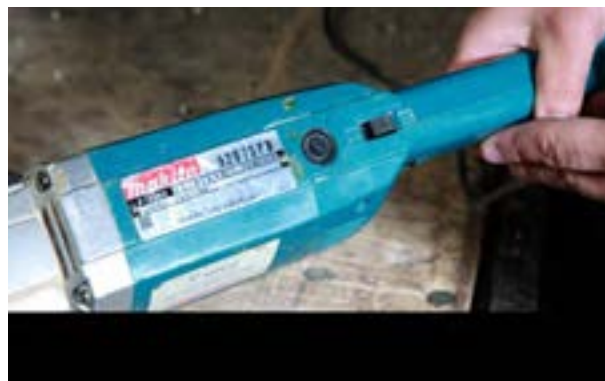
شکل ۷-۲۲- کلید تعیین دور برای سنباده‌کاری سطوح مختلف، با سفتی‌های متفاوت.
