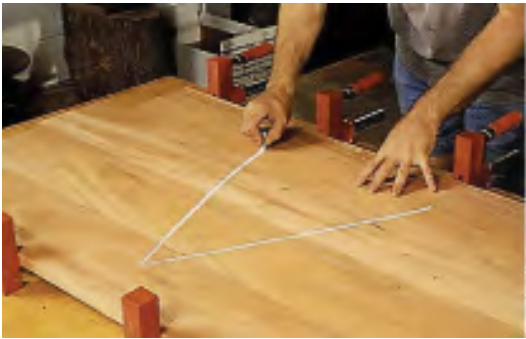
شکل ۱۴۷- تخته‌های درز شده را باید کنار هم روی تنگ‌ها قرار داد و علامت مثلث ( \Delta ) را روی آن ترسیم کرد؛ سپس باید آنها را چسب زد، در جای خود قرار داد و تنگ‌ها را محکم نمود.
