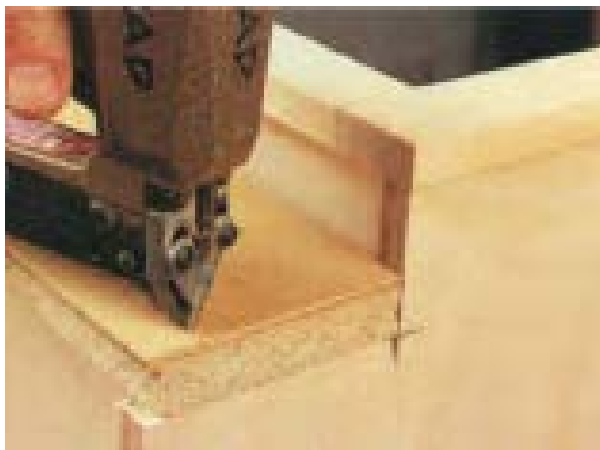
شکل ۸-۲۱- اتصال سه‌لایی به تخته خرده چوب.
