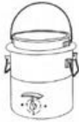
شکل ۱-۳. ظرف سیریشم الکتریکی با جای آب از ورق مس.
