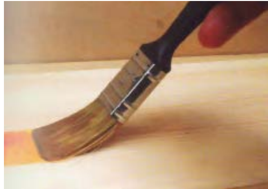
شکل ۴-۴۳- قلم‌مو را در جهت الیاف چوب بکشید.
