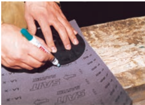
شکل ۷-۳۵- ترسیم گردی دیسک روی سنباده.
