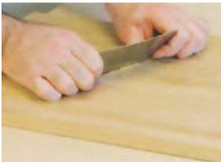
شکل ۲-۱۳- جهت حرکت لیسه، هنگام پُرزگیری.
