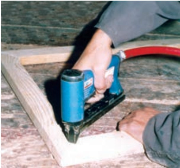
شکل ۱۶-۸- منگنه زدن روی درزهای ۴۵ درجه شده.
