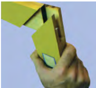
شکل ۱-۳۶- اتصال، باید با فشار ممتد دست جا برود.
