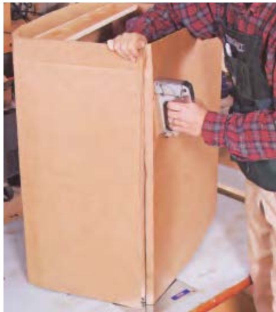
شکل ۸-۲۲- کاربرد منگنه‌ی دستی در بسته‌بندی کالاها.
