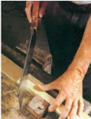
شکل ۱۱-۱۰- برش زهوار، با زاویه‌ی ۴۵ درجه.
