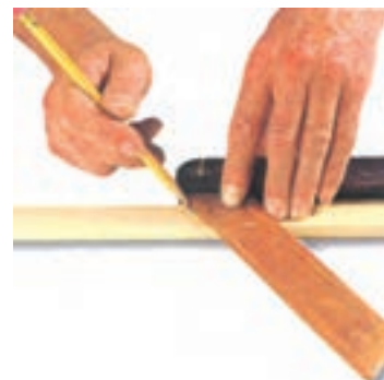
شکل ۱۰-۱۰- فطاکشی زهوار، با زاویه‌ی ۴۵ درجه.
