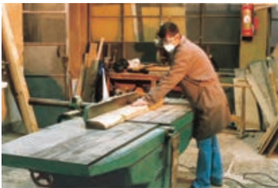
شکل ۹-۹- مقدار باز بودن زیاد گونیا، فطرآفرین است.
