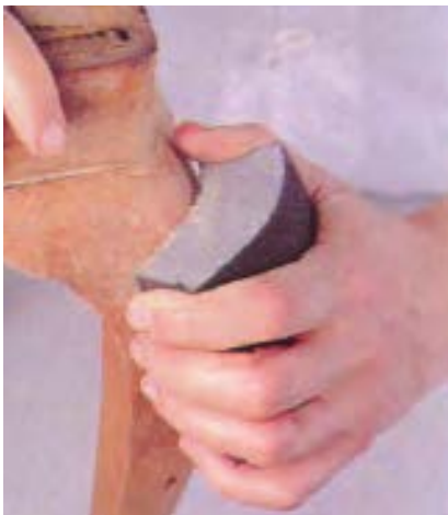
شکل ۳-۲۶- سنباده کاری قوس یک پایه ی سم آهویی.
