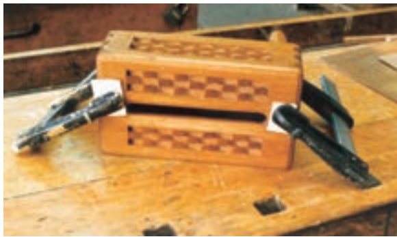
شکل ۹-۷۰- بستن سقف به بدنه‌ها.
