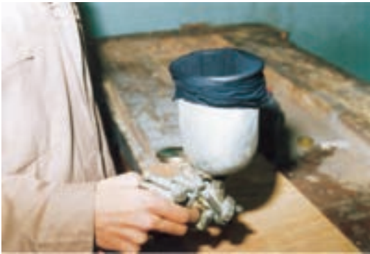
شکل ۴-۴۵- رنگ را از صافی عبور داده و ماشه‌ی پیستوله را چند بار فشار دهید.
