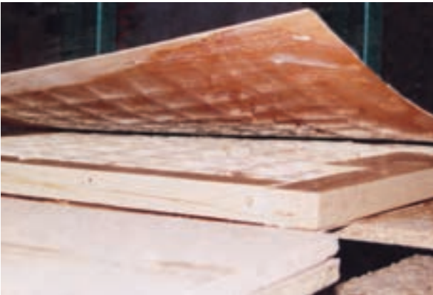
شکل ۱۱-۳۷- قرار دادن صفحه‌ی دوم، روی کلاف.
