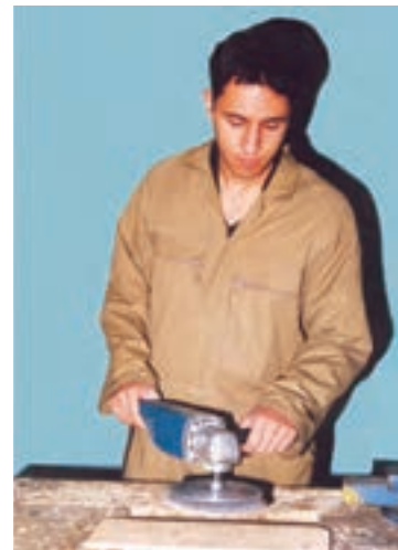
شکل ۷-۴۰- هدایت و کنترل صمغ دستگاه سنباده.
