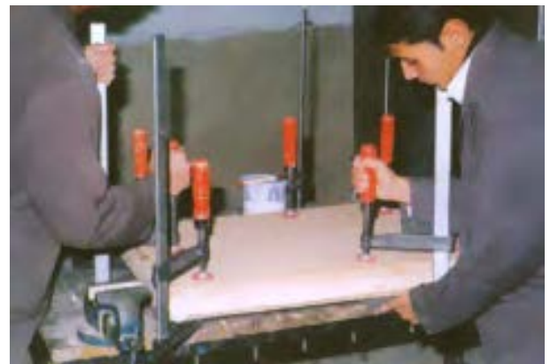
شکل ۲۳-۶- برای پرس کردن صفحات کار، از پیچ‌دستی‌های یک اندازه استفاده کنید.
