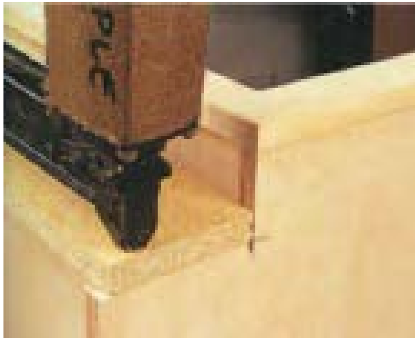
شکل ۸-۲۰- اتصال تخته خرده چوب به کابینت.
