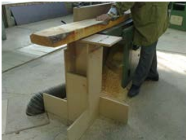
شکل ۹-۱۴- کاربرد میز کمکی برای ماشین کفرند.
