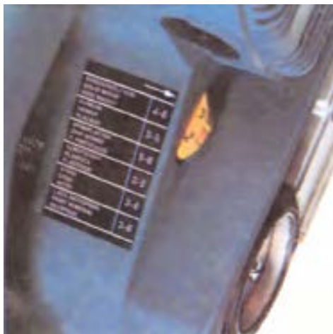
شکل ۷-۸- با ضامن تعیین دور، می‌توان دور مناسب با نوع و جنس کار را انتخاب نمود.
