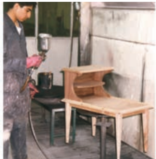
شکل ۲۴-۴. رنگ‌کاری با پیستوله (رنگ شفاف).
