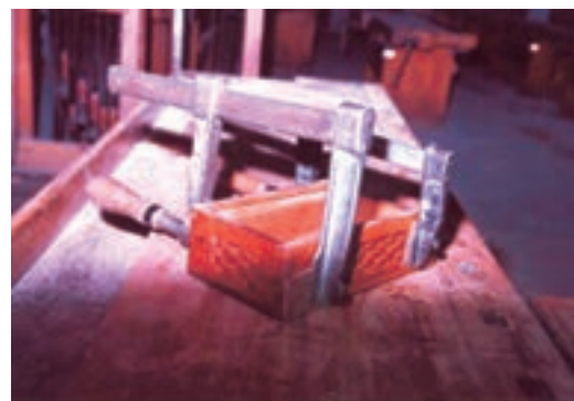
شکل ۹-۶۹- مونتاژ بدنه‌های جعبه.
