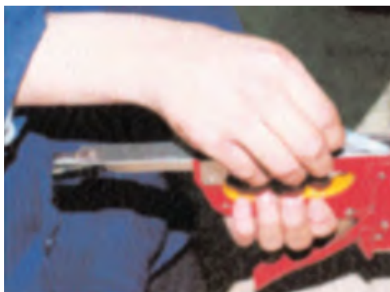
شکل ۸-۱۱- جاسازی سوزن منگنه در ممل فود.
