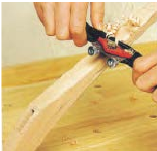
شکل ۲-۳۵. با رنده بال کبوتری، می‌توان لیسسه را به طرف فود هدایت کرد.
