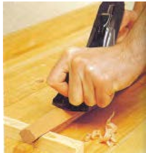
شکل ۲۷- نمونه‌ی پرداخت قید شش‌ضلعی با رنده پرداخت.
