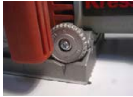
شکل ۱۷-۵- پیچ تنظیم عمق شیار.
