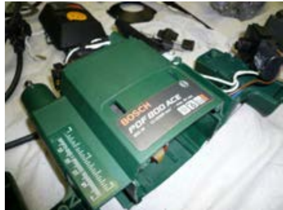
شکل ۱۶-۹- بدنه یا جلد دستگاه اورفرز.
