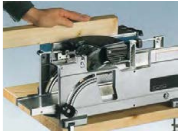
شکل ۲۰-۱۴- کاربرد میز کمکی در موقع رندیدن.
