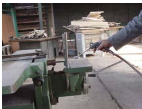
شکل ۱۰-۱۹ - غبارگیری ماشین کُمن کنی.
