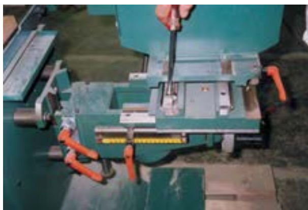
شکل ۱۰-۱۴- کنترل پیچ‌های دستگاه هدایت.
