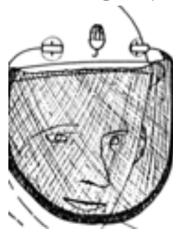
شکل ۱۱-۱۹- در هنگام عملیات فراطی، باید از عینک و ماسک مخصوص استفاده کرد.
