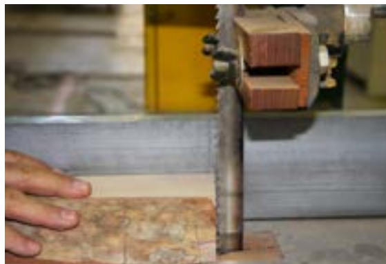
شکل ۳۲-۱- شرایط ایمنی دست، هنگام کار با اره.
