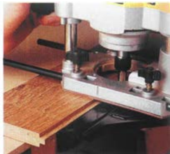
شکل ۱۶-۴. دوراهه زدن، با دستگاه اورفرز.
