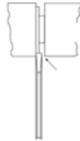
شکل ۱۱-۱۶- مغار نیزه‌ای یا قطع‌کن؛ برش عرضی.
