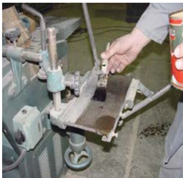
شکل ۱۰-۱۲- چرب کردن صفحات با روغن.
