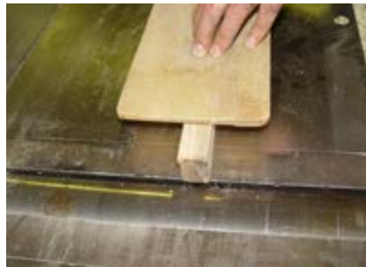
شکل ۴-۲۷ - برای رندیدن چوب‌های نازک مثل زهوار، از وسایل کمکی استفاده کنید.
