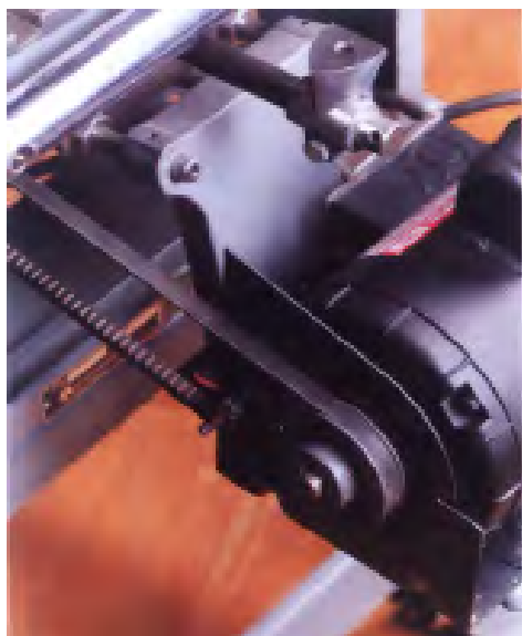
شکل ۱۲-۳۳- تسمه‌ی انتقال نیرو و حرکت.
