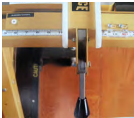
شکل ۱۲-۲۳- تنظیم اندازه‌ی برش.
