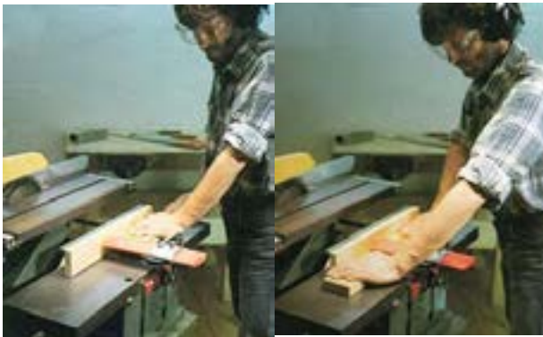
شکل ۱-۴۴-۱- گونیایی کردن چوب قبل از برش.
