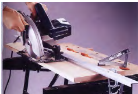
شکل ۱۳-۱۴ برش با استفاده از تکیه‌گاه.
