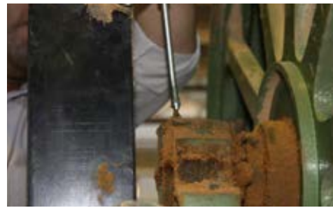
شکل ۳-۱۳- گریس کاری یاتاقان فلکه اره.
