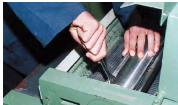
شکل ۲۴-۷. نمونه بستن تیغه‌ها به توپی.
