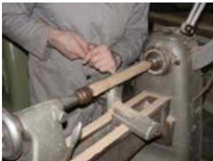
شکل ۱۱-۶۱- گرد کردن کامل قطعه چوب هشت ضلعی.
