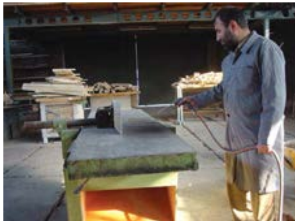
شکل ۱۲-۶- غبارگیری ماشین با شیلنگ باد.
