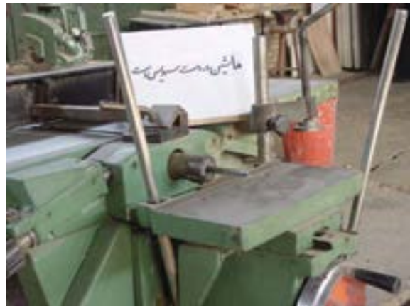
شکل ۱۰-۸- تابلوی هشدار سرویس‌کاری.
