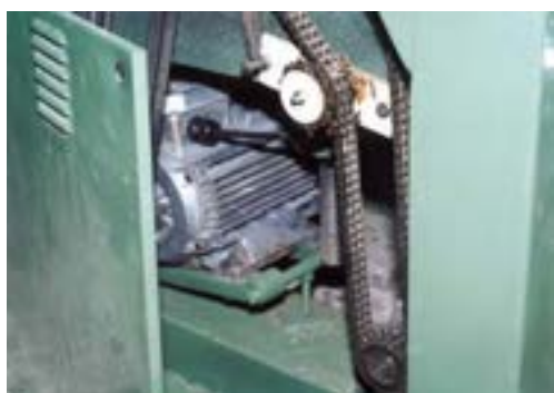
شکل ۸-۱۴- باز کردن درپوش برای روغن‌کاری.
