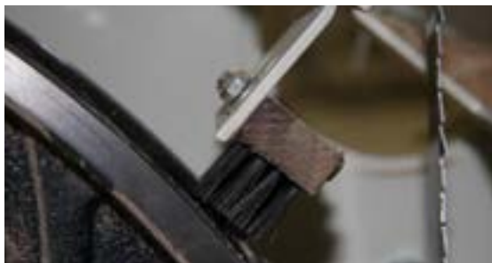
شکل ۸-۱- برس غبارگیری روی بانداژ فلکه.
