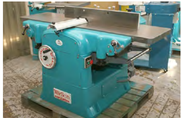
شکل ۴-۴- ماشین کفرند با بدنه چدنی.
