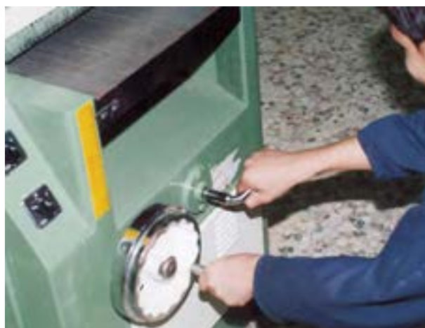
شکل ۱۹-۷- تنظیم صفحه و ممک نمودن اهرم مربوطه.
