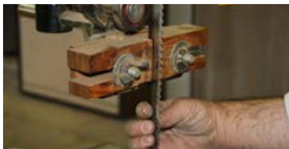
شکل ۳۴-۱- کنترل لازم تیغه قبل از کار.
