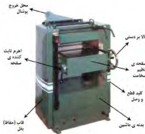
شکل ۵-۷- مشخصات ظاهری ماشین گندگی.
