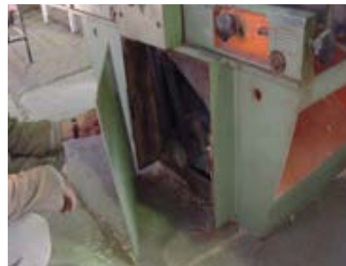
شکل ۱۴-۴- مفاظ الکتروموتور و تسمه‌ها.
