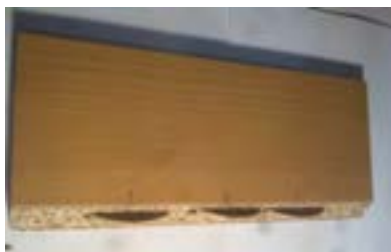
شکل ۱۳-۱۷- اتصال تمت زاویه‌ی ۴۵ درجه؛ با زاویه‌ی ۴۵ درجه‌ی گونیا.
