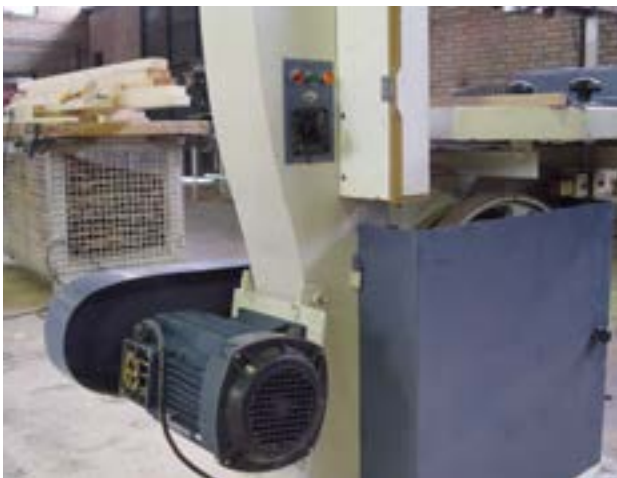
شکل ۲۷- ۱- الکتروموتور تک فاز با هازن راه انداز.
