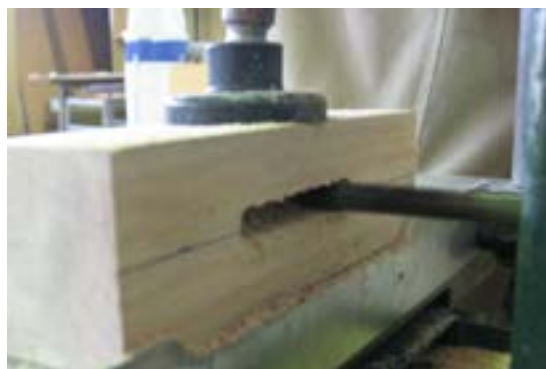
شکل ۱۰-۲- گیره‌ی نگه‌دارنده‌ی قطعه کار.
