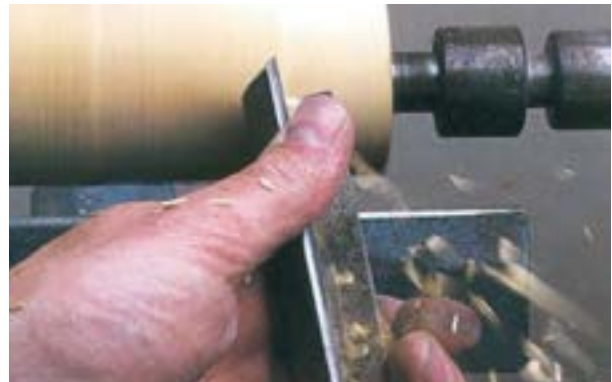
شکل ۱۱-۵۰- گرد کردن نهایی چوب با مغار گلویی.
