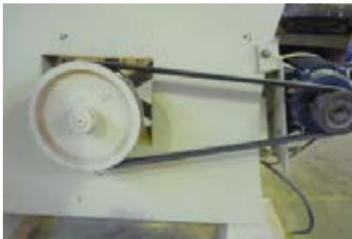
شکل ۳-۱۷- استقرار تسمه در داخل چرخ تسمه.
