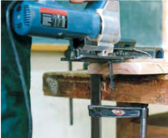
شکل ۱۵-۳۵. صفحه، کاملاً روی چوب قرار نگرفته است.
