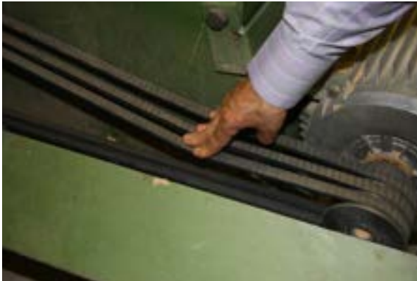
شکل ۱-۲۲-۱- تنظیم سفتی تسمه
