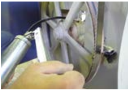
شکل ۳-۳- گریس کاری کتسو جابجایی فلکه‌ی بالا.
