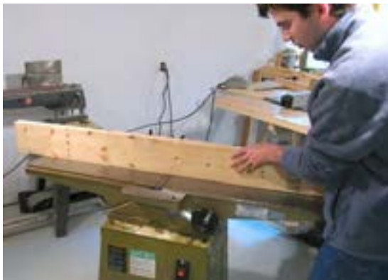
شکل ۴-۲۴ - پس از رندیدن (و، باید نر چوب را نیز رنده کرد.
