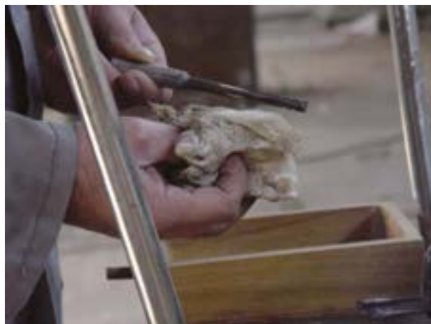
شکل ۱۶-۱۰- تمیز کردن مته‌های خارج شده از ماشین.
