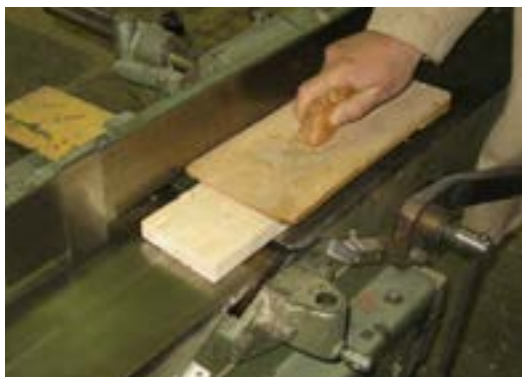
شکل ۱۷-۱۴- ب - رنده کردن چوب‌های کم ضخامت.
