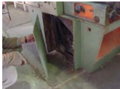
شکل ۹-۶ حفاظ تسمه در جای خود قرار گیرد.
