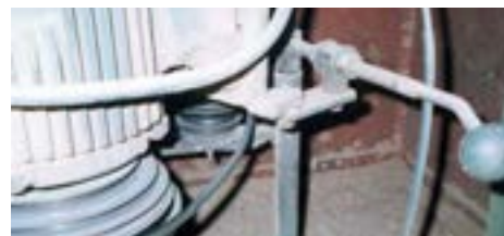
شکل ۳-۱۴- باز کردن درپوش (روی تسمه‌ها).
