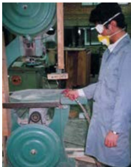
شکل ۱۱-۳. نظافت ماشین پس از کار.
