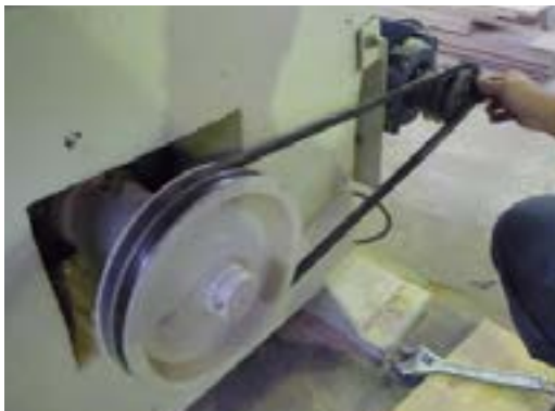
شکل ۳-۱۶- تعویض تسمه فرسوده.
