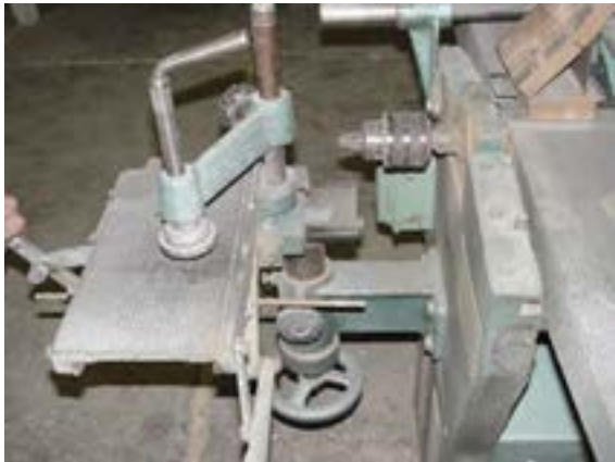
شکل ۲-۹ - ماشین سه‌کاره شامل: کُم‌کنی، رنده و
