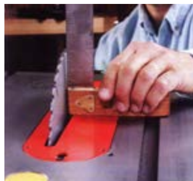
شکل ۱۶-۱۲- کنترل زاویه‌ی تیغه.
