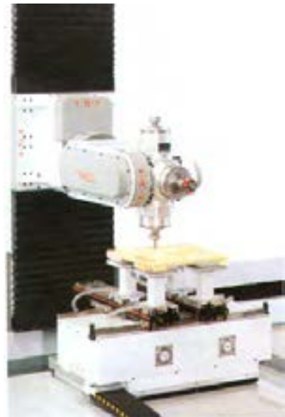
شکل ۸- دستگاه C.N.C برش بر روی چوب.
