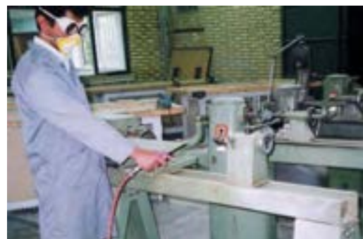
شکل ۱۱-۴۴- گردگیری و نظافت ماشین فراطی.
