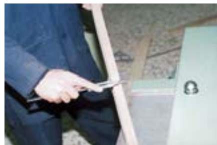
شکل ۴۸-۷- کنترل ضخامت چوب گندگی شده، با کولیس.
