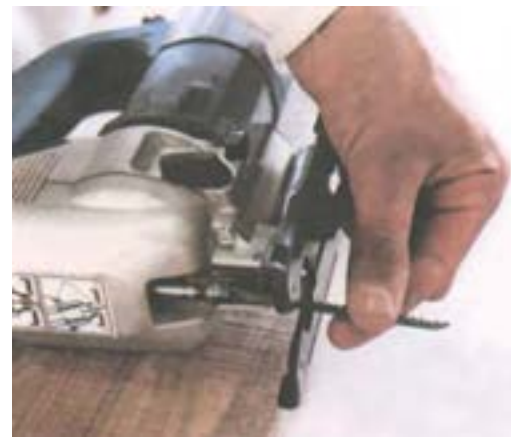
شکل ۱۴-۱۵- تعویض تیغه اره.
