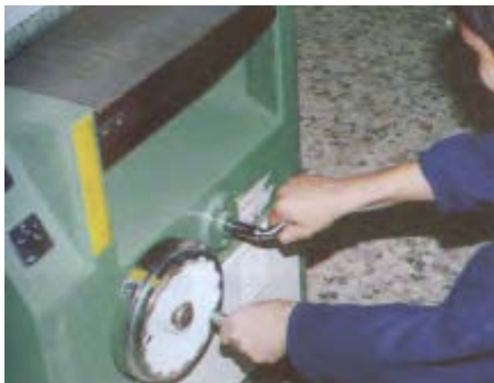
شکل ۷-۵۱- تثبیت بالابر، پس از تعیین اندازه.
