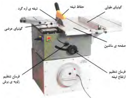
شکل ۱۲-۱ ماشین اره گرد میزی یا مجموعه‌ای.
