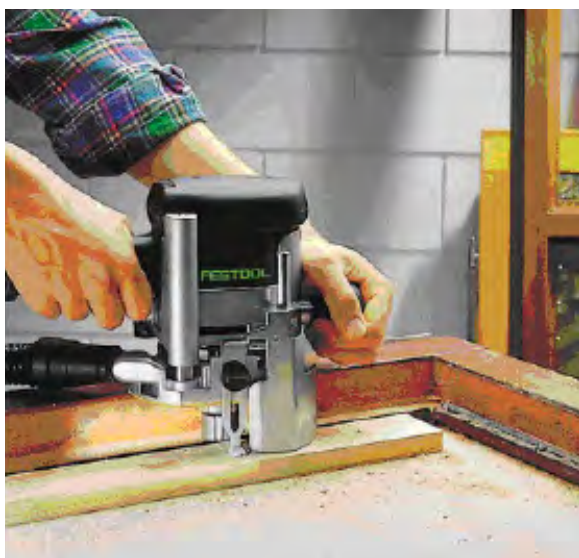
شکل ۱۶-۷- برداشتن قسمت اضافی سه لایی.
