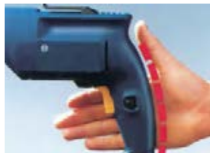
شکل ۱۹-۴۰- دسترسی دکمه‌ی روشن و خاموش دریل.
