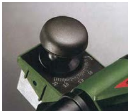
شکل ۴- ۱۴- پیچ تنظیم صممه برای پوشالبرداری
