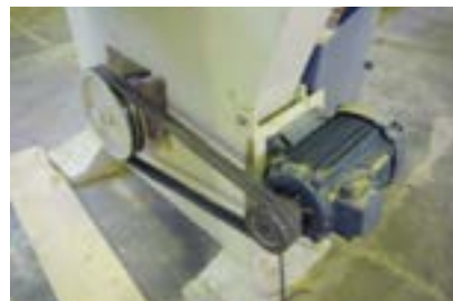
شکل ۲۸-۱ الکتروموتور دو تسمه‌ای.
