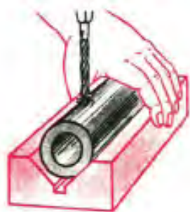
شکل ۱۹-۳۸- سوراخ‌کاری جسم استوانه‌ای.
