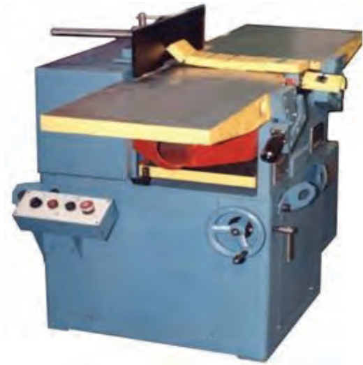
شکل ۳۳-۴- ماشین رنده با حفاظ.
