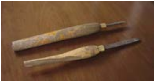
شکل ۱۱-۲۰- نمونه‌ای از مغارهای با دسته‌ی معیوب.
