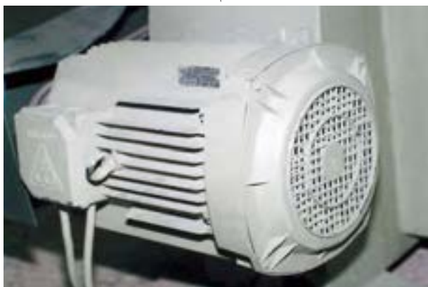
شکل ۲۶- ۱- الکتروموتور سه فاز.
