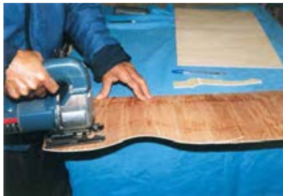
شکل ۲۱- ۱۸. برش تخته سه‌لایه با توجه به طرح الگو.
