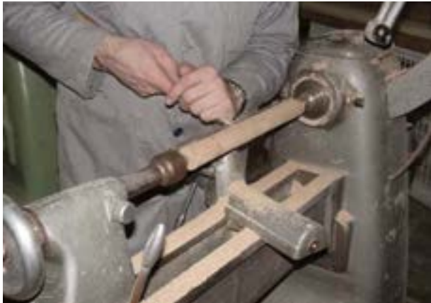
شکل ۱۱-۲۷- نمونه‌ی قرار گرفتن مغار گلوبی هنگام فراطی.
