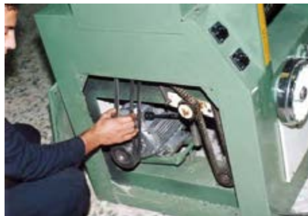
شکل ۸-۸- کنترل مقدار کشش تسمه‌ها.
