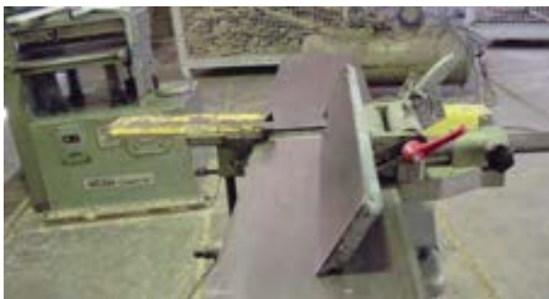
شکل ۳۴-۴- تنظیم زاویه ۴۵ درجه گونیای رنده.
