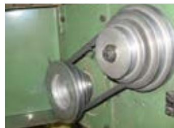
شکل ۶-۱۱- پولی تبدیل دور.
