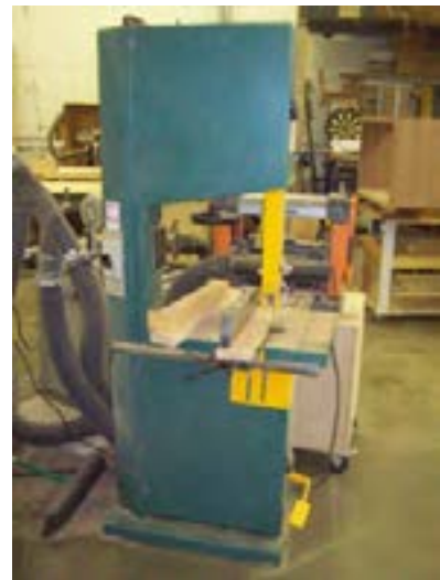
شکل ۹-۱. یک ماشین اره‌نواری، با مفاظ کامل.
