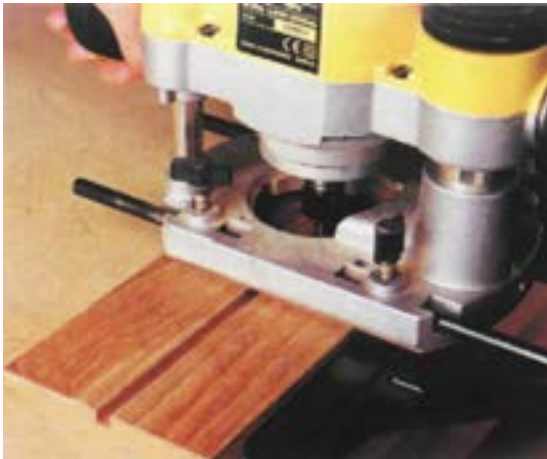
شکل ۱۶-۳. کنشکاف زدن، با دستگاه اور فرز.
