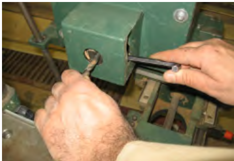
شکل ۹-۱۷- ممکن کردن مته داخل سه‌نظام.
