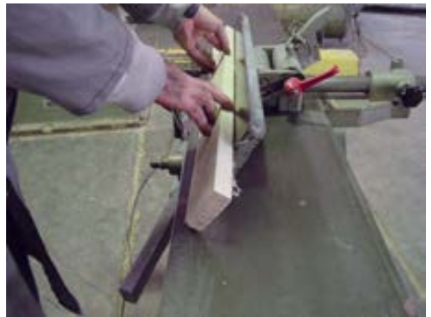
شکل ۴-۳۵. رنده کردن نر چوب با زاویه ۴۵ درجه.
