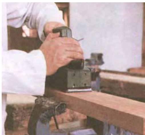
شکل ۱۷-۱۴. نمونه‌ی بستن چوب دافل گیره
