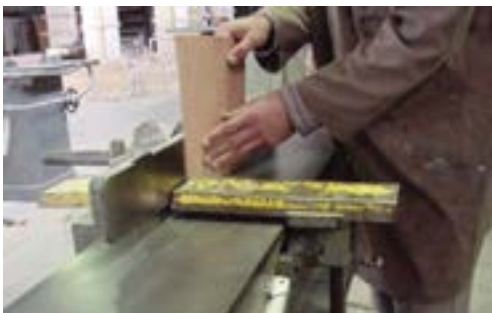
شکل ۱۸-۱۴- استفاده از حفاظ تیغه در رندیدن چوب‌های با ضخامت کم.
