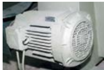
شکل ۵-۱۱- الکتروموتور سه‌فاز یک ماشین خراطی.
