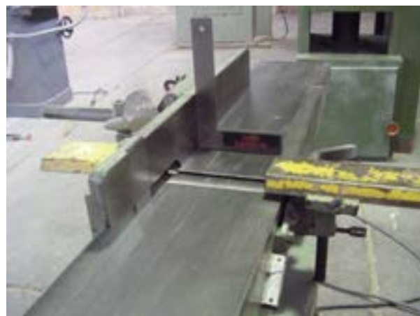
شکل ۳۰-۴. کنترل گونیا ماشین.
