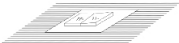
شکل ۱۴-۱۵- کلید تنظیم برق ۱۱۰ به ۲۲۰ ولت و برعکس.
