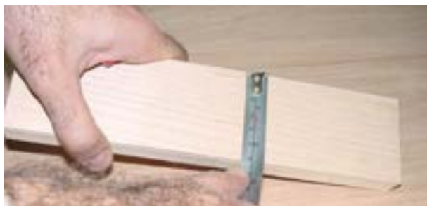
شکل ۳۶-۷- اندازه‌گیری نهایی قطعه کار.
