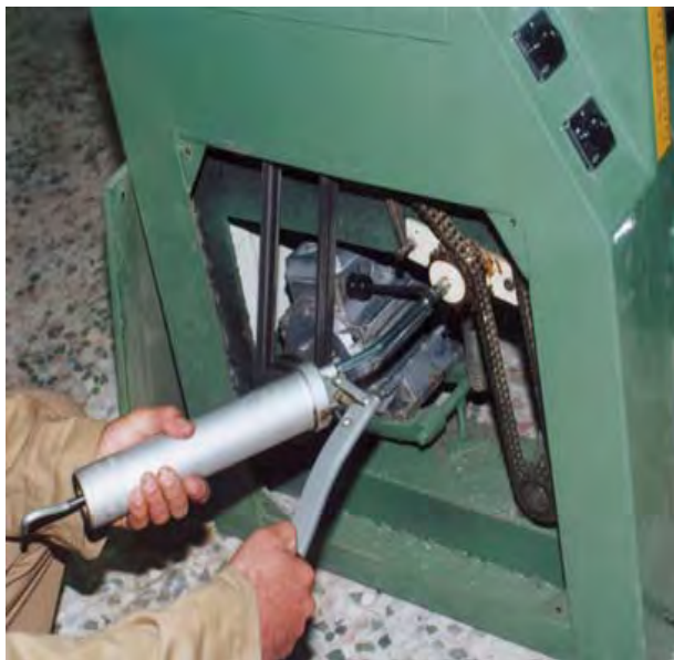
شکل ۸-۷- گریس‌کاری ممبرهای انتقال نیرو.
