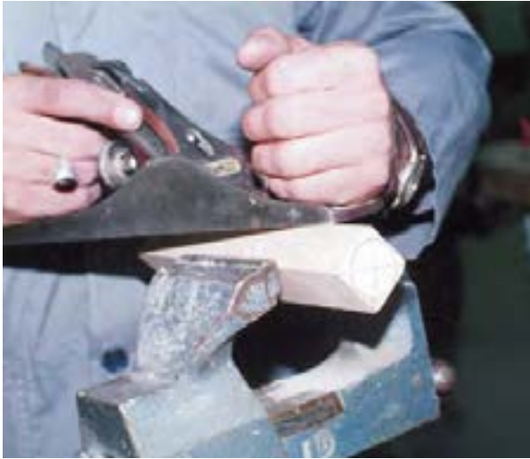
شکل ۱۱-۲۴- پخ زدن گوشه‌های تیز چوب.
