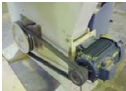
شکل ۳-۴- انتقال نیرو توسط تسمه.
