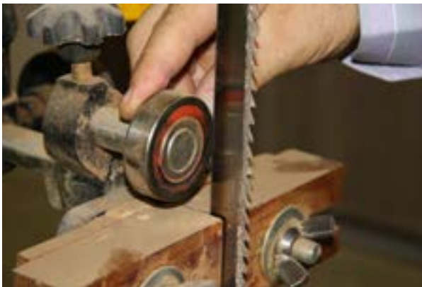
شکل ۳۰-۱- کنترل بلبرینگ پشت تیغه.
