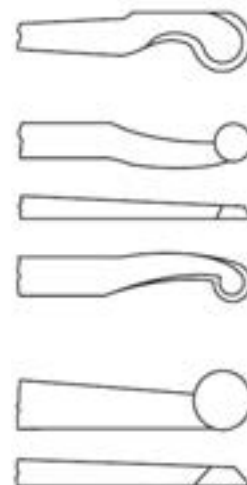
شکل ۱۱-۱۷- مغار(های) مخصوص سطوح مقعر و فضاهای داخلی.
