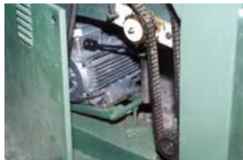
شکل ۱۳-۷. حفاظ تسمه، زنجیر، الکتروموتور و ...
