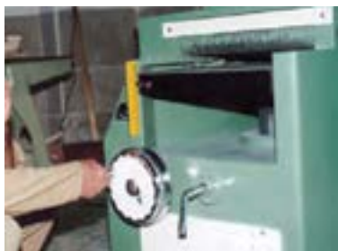
شکل ۲۱-۷- آزمایش (۹۰) بودن حرکت صفحه‌ی متمرک.
