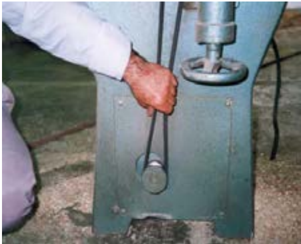
شکل ۱۰-۱۰- کنترل تسمه‌ی ماشین.
