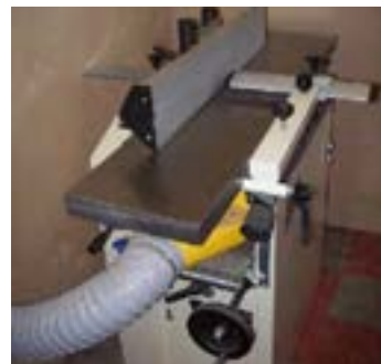
شکل ۴-۲۲ - مکنده‌ی قابل اتصال به ماشین کفرنده.
