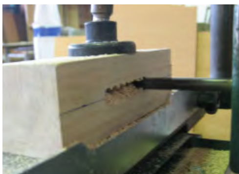
شکل ۹-۳۸ - برداشتن فاصله‌ی دو سوراخ.
