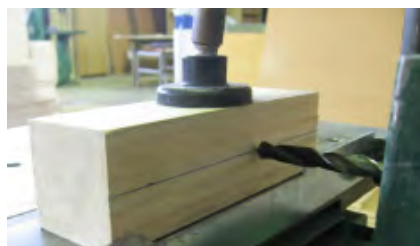
شکل ۹-۱۸- تنظیم نیش مته با فط وسط چوب.
