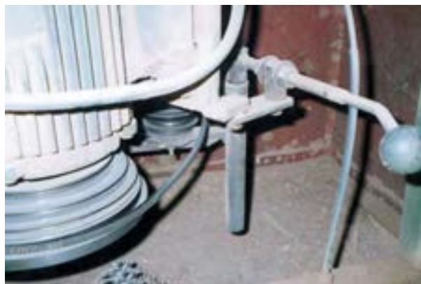
شکل ۱۱-۶- خارج کردن تسمه از پولی.
