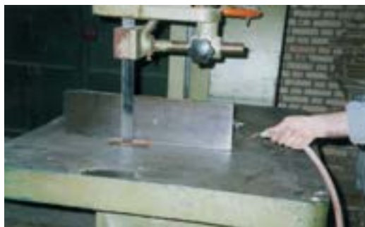
شکل ۱۸-۳. نظافت و گردگیری پس از پایان کار.
