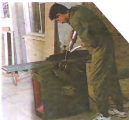
شکل ۱۴-۶- گریس‌کاری یاتاقان‌های توپی رنده.
