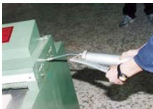
شکل ۸-۱۳- گریس‌کاری یاتاقان‌های ماشین.
