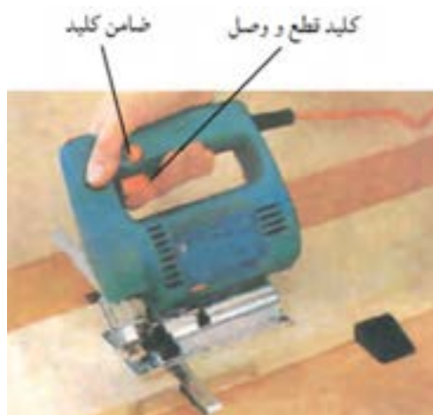
شکل ۱۴-۱۵- کلید قطع و وصل و ضامن کلید.
