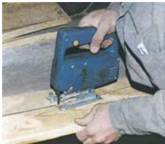
شکل ۱۹-۱۵. برش طولی چوب بدون استفاده از گونیا.
