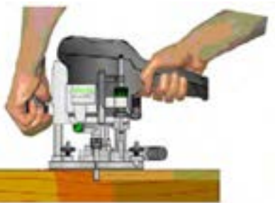
شکل ۱۶-۲۶- دوراهاه (زدن قطعه کار با دستگاه اورفرز).
