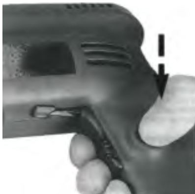
شکل ۱۹-۴۲- فشردن ضامن کلید.
