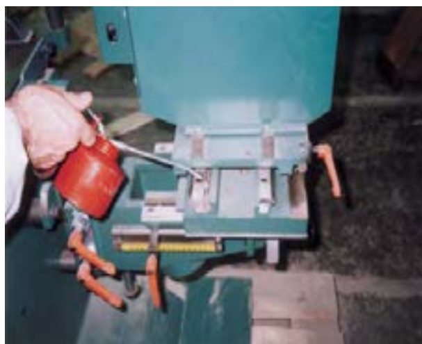
شکل ۱۰-۱۳- (روغن‌کاری) ممل (ریل‌ها).
