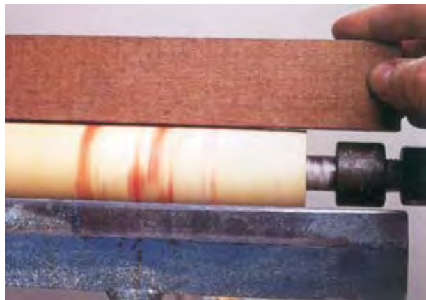
شکل ۱۱-۵۱- کنترل صافی قطعه چوب گرد شده.
