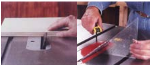
شکل ۱۷-۱۲- کنترل زاویه با گونیا و یا خط مورب ترسیم شده روی قطعه کار.
