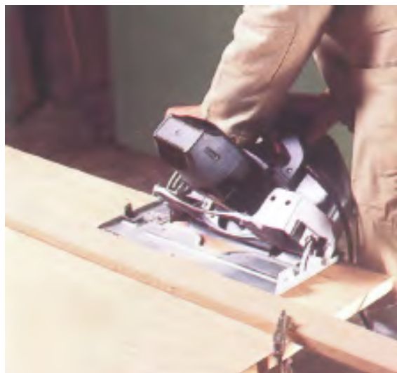
شکل ۱۳-۱۲ صفحه‌ی دستگاه تمت زاویه تنظیم شده است.
