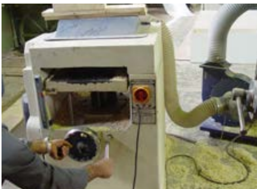
شکل ۷-۴۶- تنظیم بار تیغه به اندازه‌ی مورد نیاز.
