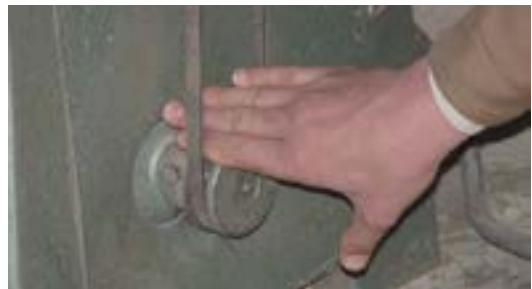
شکل ۶-۵ - مراقبت از انگشتان به هنگام تعویض تسمه.
