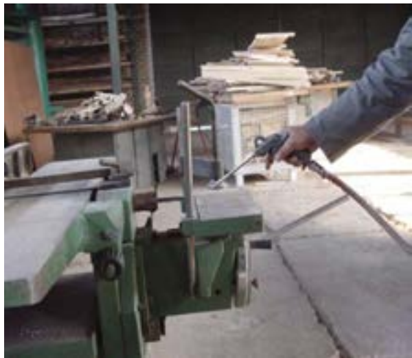
شکل ۱۰-۱۱- غبارگیری قطعات ماشین.
