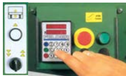
شکل ۲-۷- کلید و راهنمای بالابر اتوماتیک و تنظیم ضخامت با دقت بسیار زیاد.
