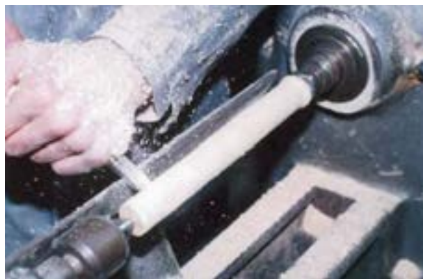
شکل ۱۱-۶۲- یکنواخت کردن چوب.
