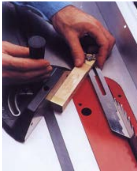
شکل ۲۰-۱۲- تنظیم زاویه‌ی تیغه
