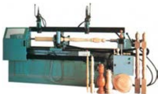
شکل ۱۱-۲ - ماشین فرایمی نیمه اتوماتیک.
