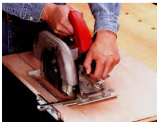
شکل ۱۳-۱۶ برش با استفاده از گونیای ماشین.
