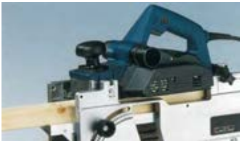
شکل ۲۲-۱۴- گندگی کردن چوب با استفاده از میز کمکی.
