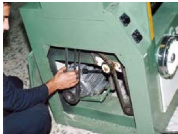
شکل ۸-۱۶- کنترل تسمه‌های انتقال نیرو
