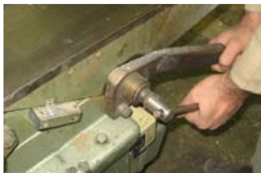
شکل ۱۳-۵- تنظیم مقدار بار.
