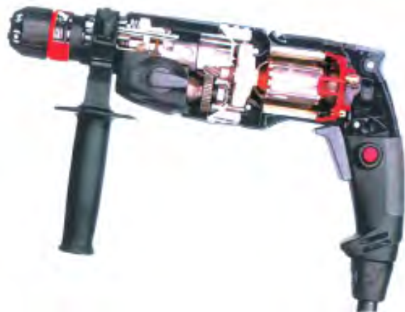
شکل ۱۹-۴۵- وضعیت قرارگیری قطعات در داخل پوسته‌ی دریل.
