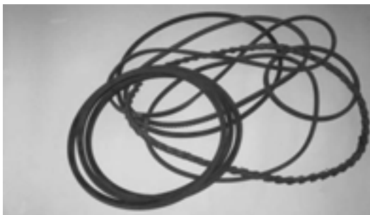
شکل ۱۰-۴- انواع تسمه‌های انتقال نیرو.
