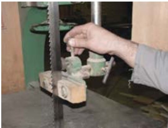
شکل ۵۲-۱- نمونه‌ی تنظیم فاصله‌ی بلبرینگ با پشت تیغه.
