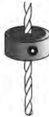
شکل ۱۹-۵۳- قطعه به‌جای میله‌ی عمق سنج.
