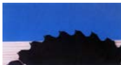
بیرون زدگی تیغه، مناسب است.
