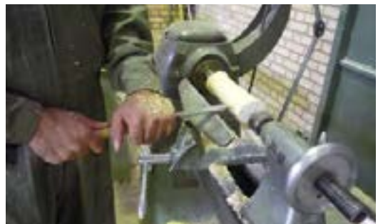
شکل ۱۱-۵۵. نمونه‌ی گرد کردن قطعه چوب پخ‌شده.
