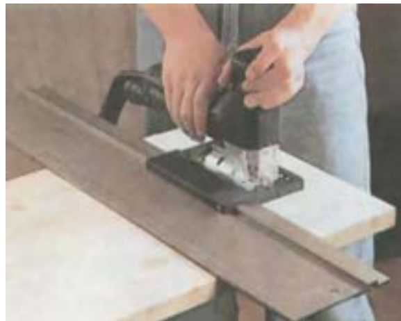
شکل ۲۰-۱۵. برش عرضی چوب به کمک ریل راهنما.
