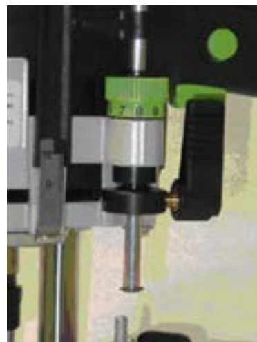
شکل ۱۳-۱۶- درجه‌ی تعیین ارتفاع تیغه.
