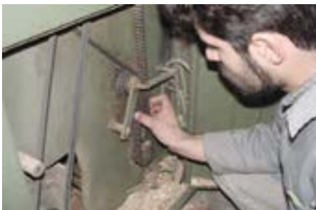
شکل ۲۷-۷. تنظیم و آزمایش سفتی زنجیر انتقال نیرو.
