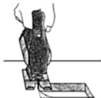
شکل ۱۵-۳۷- نمونه‌ی بریدن گوشه‌های داخلی با زاویه‌ی ۹۰ درجه.
