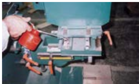
شکل ۱۰-۲۰ - (روغن کاری ریل‌ها).
