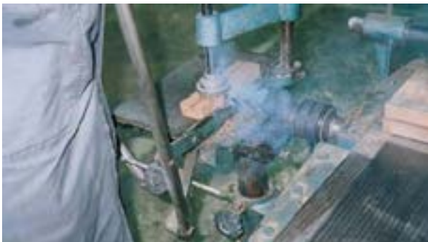
شکل ۹-۲۶- سوفتن چوب به هنگام کم کنی.
