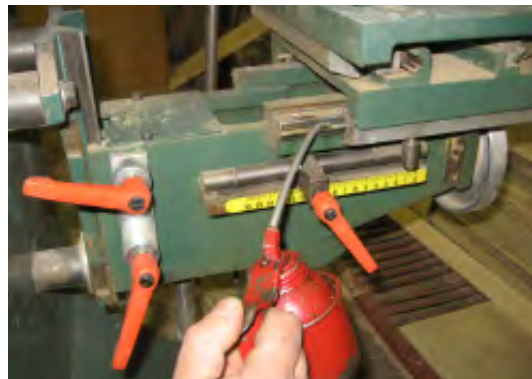
شکل ۱۰-۱- (روغن‌کاری ریل‌ها و کشوهای صفحه‌ی متمرک).
