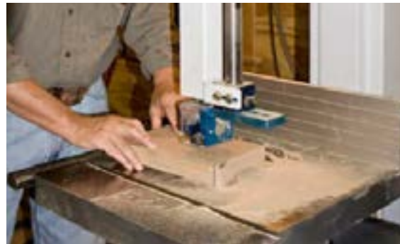
شکل ۱-۳۵-۱- فاصله‌ی ارتفاع سطح چوب با دستگاه هدایت.
