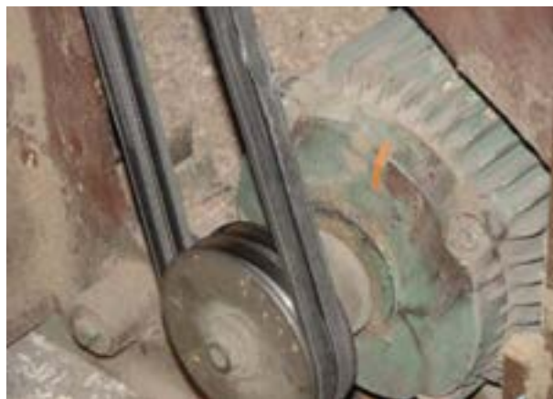
شکل ۱۰-۴- الکتروموتور ماشین کفرنده.
