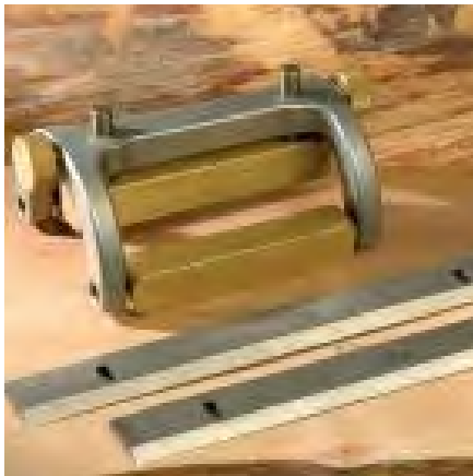
شکل ۸-۵. دستگاه تنظیم ارتفاع تیغه.
