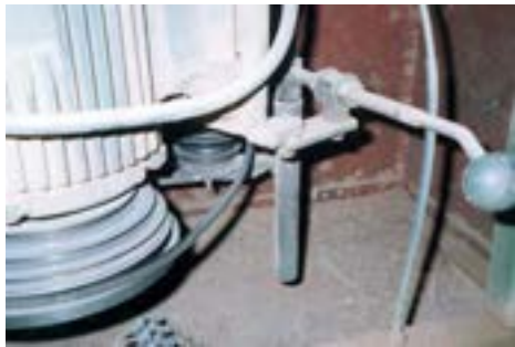
شکل ۳-۱۵- اهرم الکتروموتور، آزاد است.
