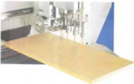
شکل ۵- CNC سوراغ‌کاری و برش‌کاری MDF.
