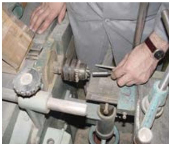
شکل ۱۰-۷- فارغ کردن مته از سه‌نظام.
