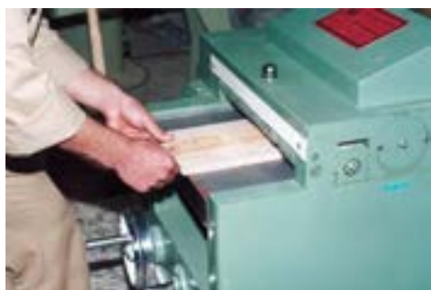
شکل ۳۷-۷- نمونه‌ی زدن چوب نازک.
