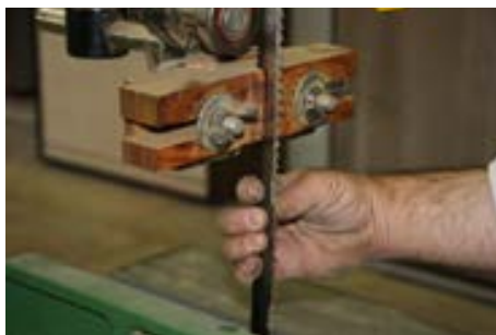
شکل ۲۰-۱- کنترل مستمر مقدار کشش مناسب تیغه و... قبل از شروع به کار.
