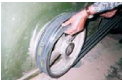
شکل ۹-۳- پگونگی تعویض تسمه.
