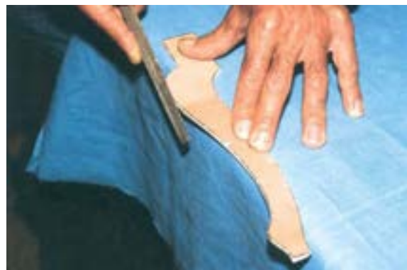
شکل ۲۲- ۱۸. نمونه‌ی پرداخت کردن مسیر برش.
