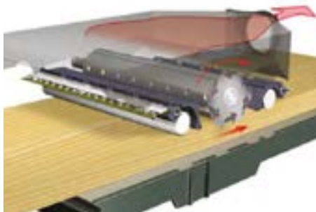
شکل ۸-۷- غلتک آبدار، توپی تیغه‌ها و غلتک صاف.
