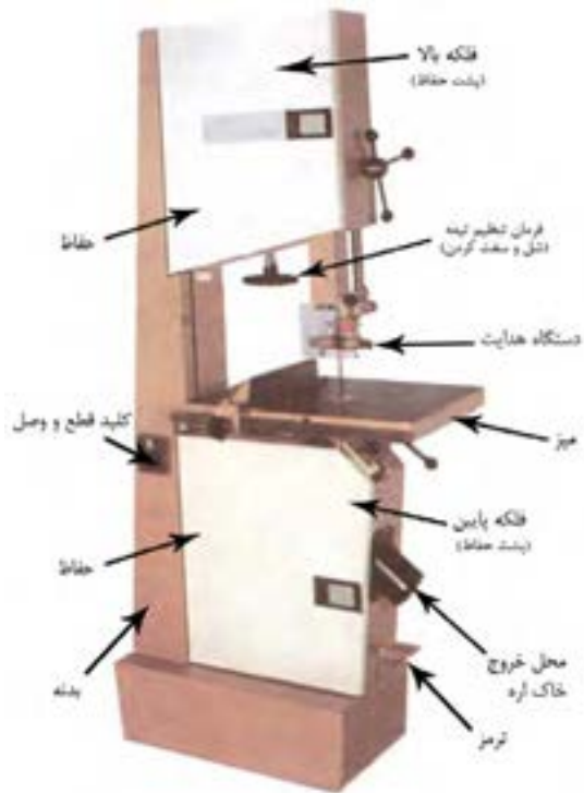
شکل ۴۱-۱. قسمت‌های مختلف یک ماشین اره‌نواری.
