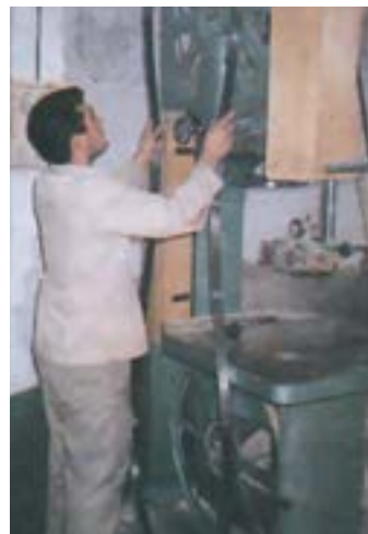
شکل ۱۰-۲- نمونه‌ی خارج کردن تیغه اره.
