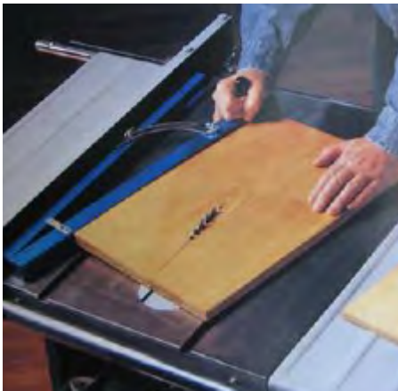
شکل ۱۲-۲۹- برش مورب با ابزار کمکی.
