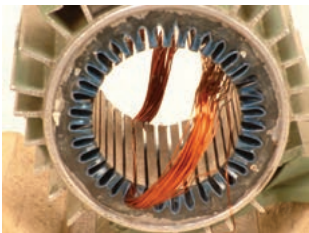
شکل ۲-۷- قرارگرفتن یک بازو در داخل یک شیار
