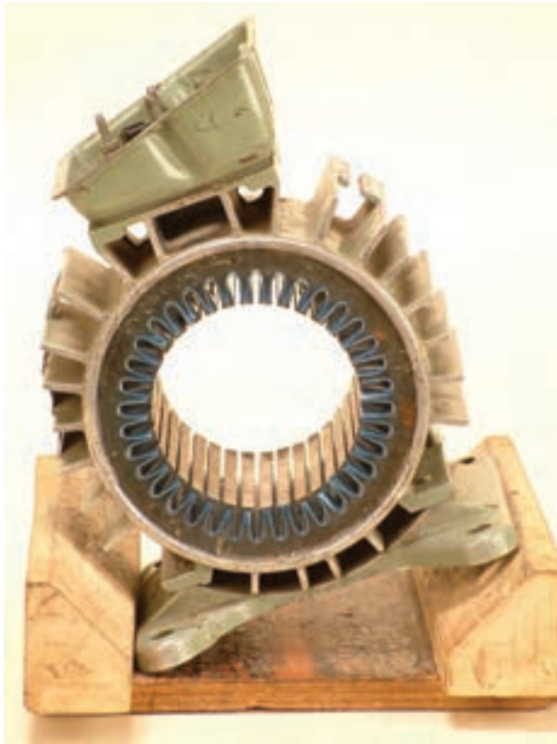
شکل ۲۹-۲-ب - انتخاب شیار شروع سیم بندی
