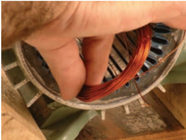
شکل ۲-۱۵- قراردادن بازوی شماره یک در شیار شماره ۱
