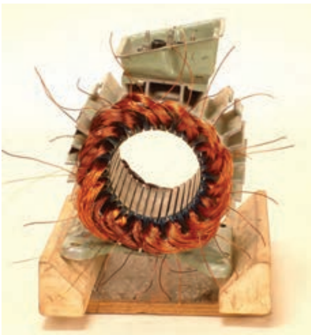
شکل ۱۳-۳- شماره گذاری شیارها
