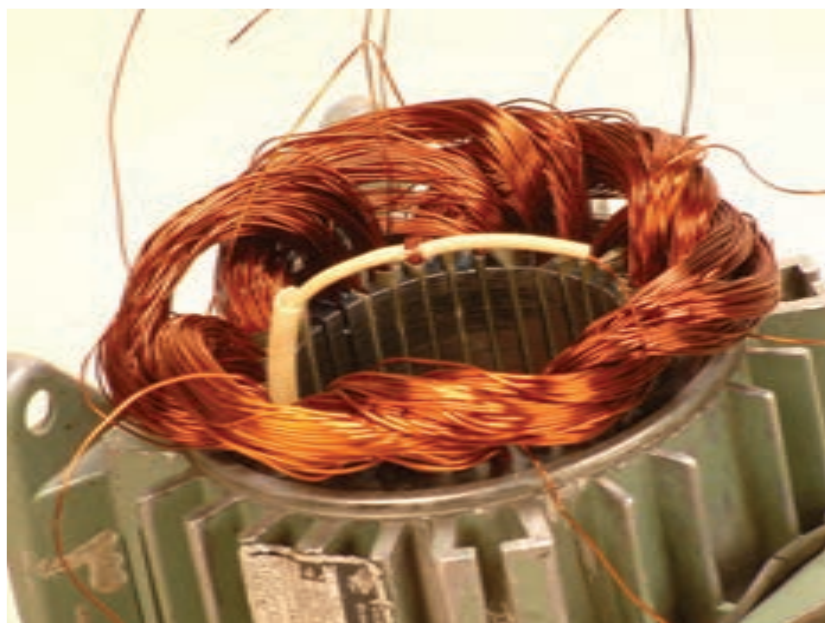
شکل ۳-۹- هدایت وارنیش‌ها به محل لحیم شده
