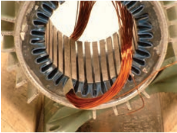
شکل ۲-۹- پوشاندن روی بازوها توسط کاغذ پرشمان
