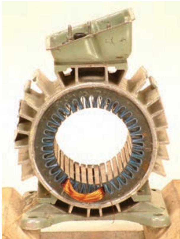
شکل ۲۹-۲-ج - قراردادن کلاف شماره ۱
