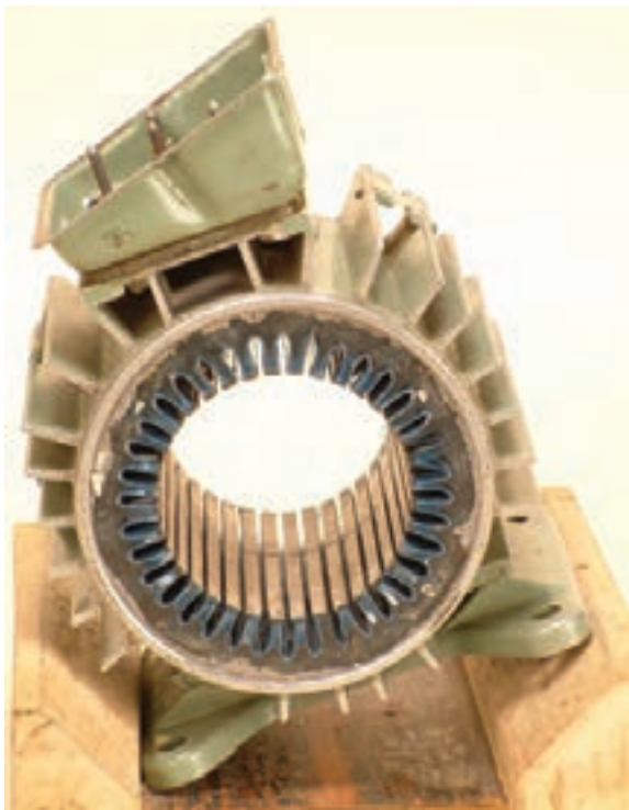
شکل ۱۳-۲- انتخاب شیار شروع و مسیر کلاف‌گذاری
