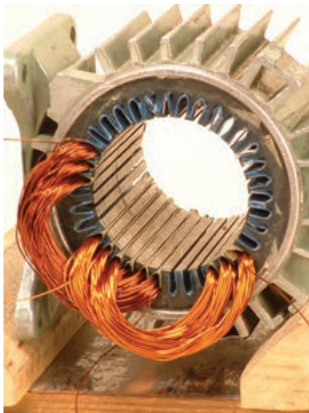
شکل ۲-۲۱- قرارگرفتن بازوهای گروه کلاف دوم در داخل شیارها
