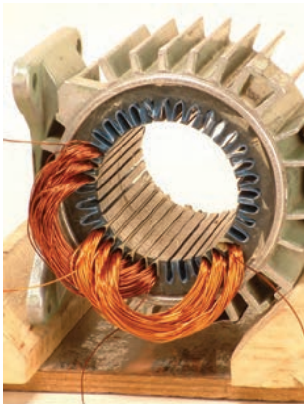
شکل ۲-۲۲- شروع گروه کلاف سوم از شیار شماره ۱۳
