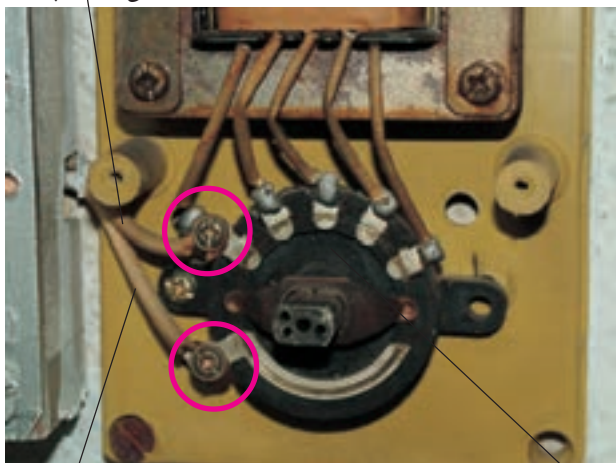
سیم رابط فاز ورودی به کلید
