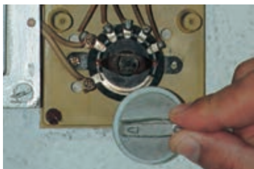
شکل ۷-۳۷۶ سیم رابط فاز خروجی کلید به پنکه
