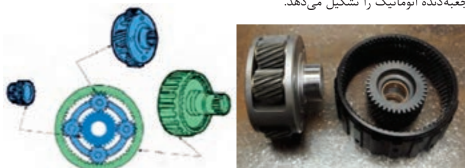
شکل ۱۴- مکانیزم چرخ دنده سیاره‌ای (خورشیدی)
