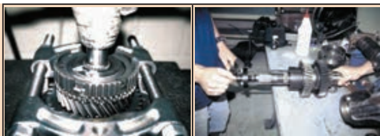
تفکیک اجزا مجموعه جعبه دنده از روی محورها با کمک پرس و ابزار مخصوص
