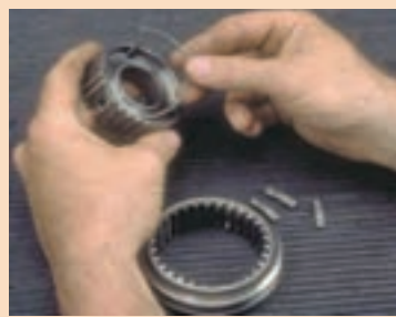
بررسی و بستن مجموعه سنکرونیزه
