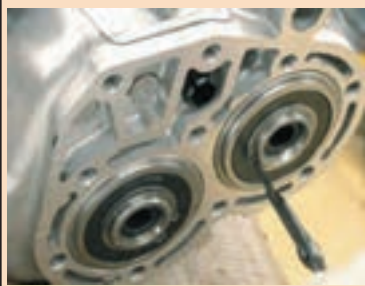
بستن و کنترل بلبرینگ محورها
