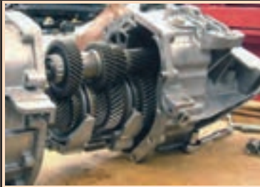
باز کردن بوسته جعبه دنده
