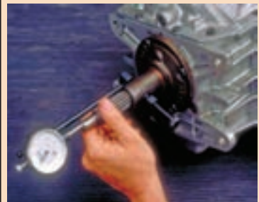
کنترل لقی طولی محور ورودی
