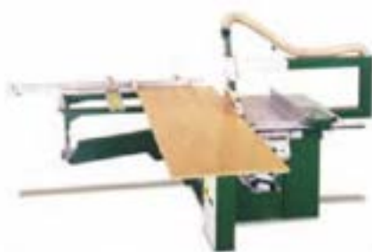
شکل ۳۷-۱- ماشین اره گرد با میز کنکری کتونی
