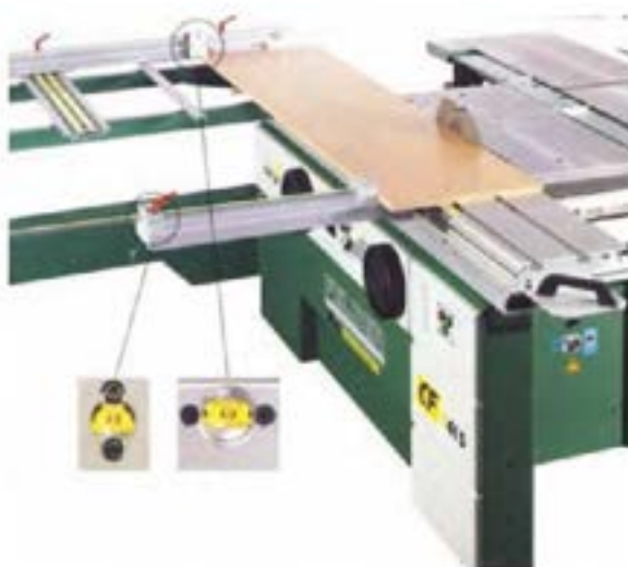
شکل ۳۸-۱- ماشین اره گرد صفحه‌بر با میز کنکری کتونی
