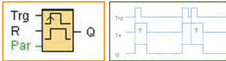
شکل ۳۶- دیاگرام زمانی Edge Triggered Wiping Relay Timer شکل ۳۷- شمای گرافیکی Edge Triggered Wiping Relay Timer
