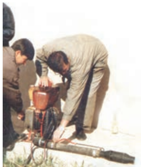
شکل ۲۵-۳- آماده سازی و روشن کردن شعله افکن
