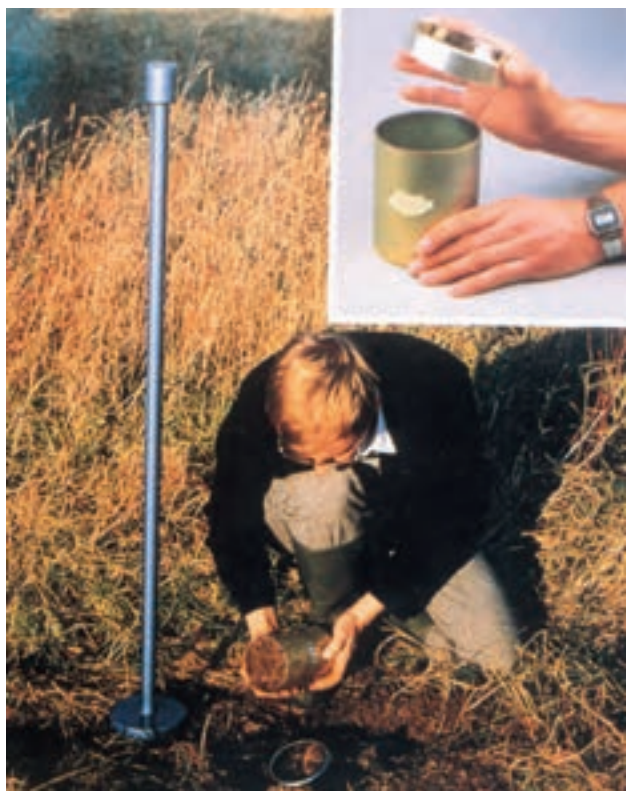
شکل ۱۶- ۱ نمونه برداری از خاک با سیلندر
