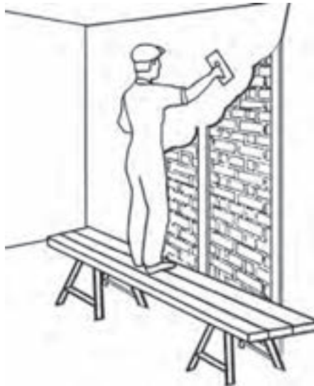
شکل ۸-۵- طریقه‌ی گچ کاری دیوار
