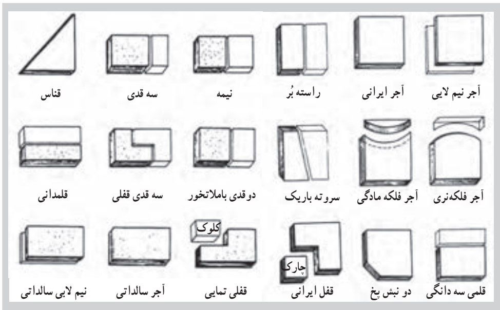
۱۳-۶- اجزای آجر و انواع تراش‌های روی آن
