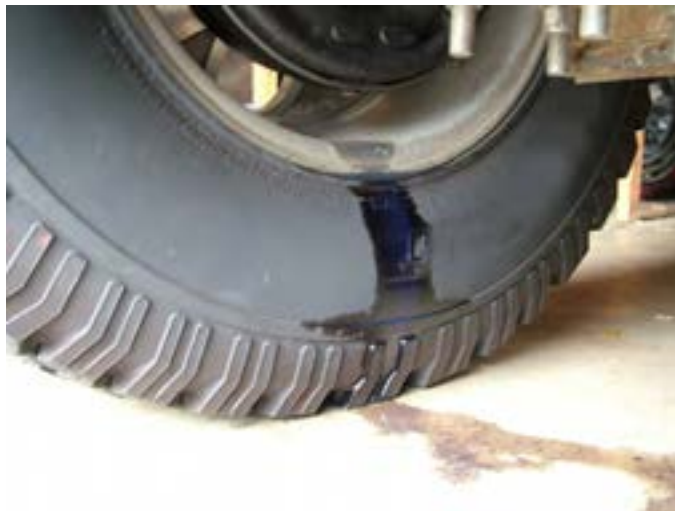
شکل ۴۱- وجود روغن اطراف چرخ عقب
