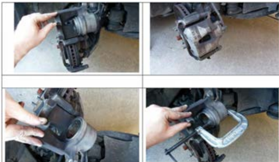
شکل ۳۳- مراحل باز کردن کالیپر ترمز
