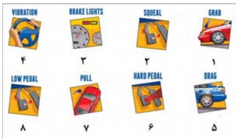
شکل ۲۱- آثار مهم خرابی سیستم ترمز
