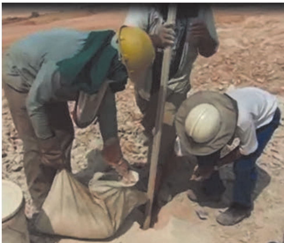
ریختن مواد منفجره (آنفو) درون چال و کوبیدن به وسیله سمبه چوبی
