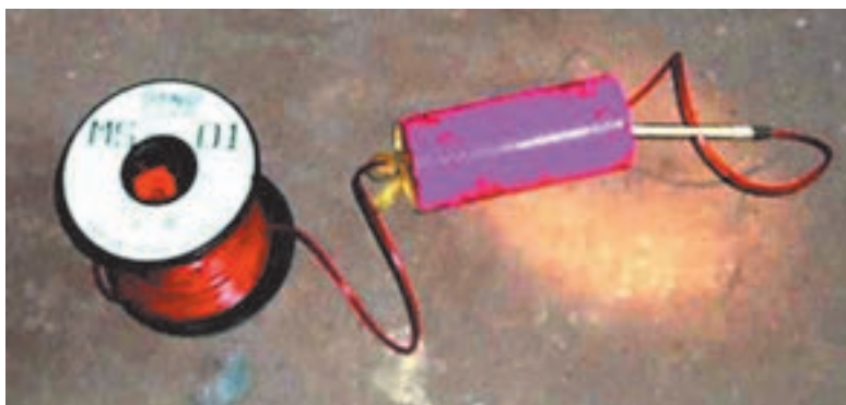
طریقه قرار دادن چاشنی درون دینامیت
