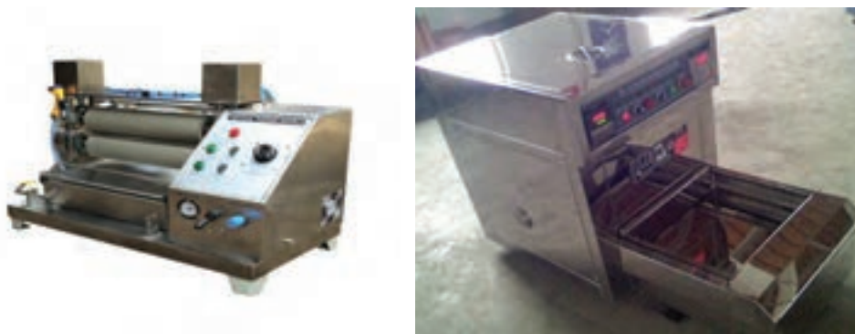
شکل ۱۱ ماشین رنگرزی ترموزول و فولارد آزمایشگاهی
