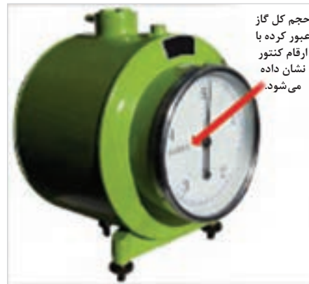
شکل ۲۷- نمای بیرونی جریان سنج گاز به روش تر (که در آزمایشگاه‌ها کاربرد دارد- با یکای لیتر در ثانیه)
