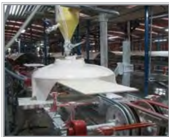
شکل ۲۷- لعاب‌زنی به روش آبشاری
