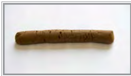
گل با شکل‌پذیری نامناسب - دارای ترک
