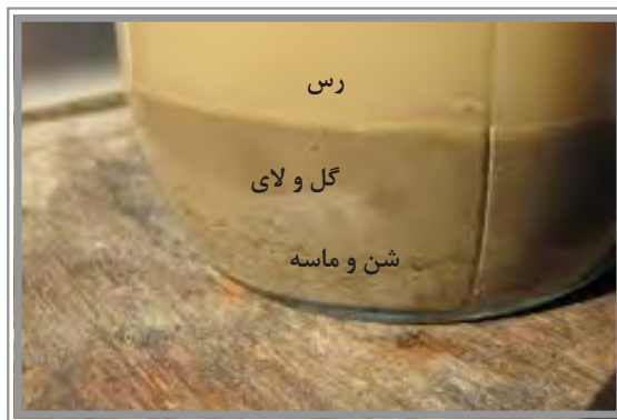
شکل ۱۹- لایه‌های مختلف دوغاب رس
