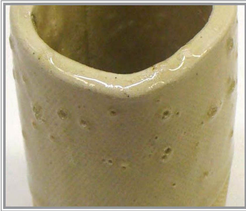
شکل ۳۸- عیب تاول زدن لعاب
