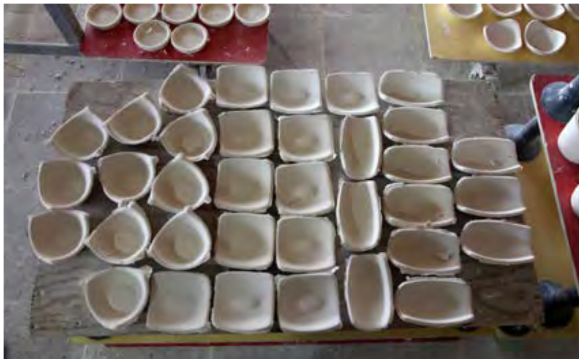
شکل ۱۲- ناهمواری و زوائد روی سطح قطعات مختلف سرامیکی
