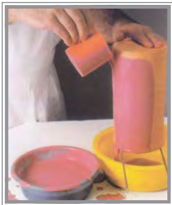
شکل ۱۸- اعمال لعاب به روش ریختنی
