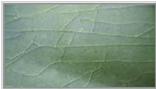
شکل ۳۱- عیب ترک برداشتن لعاب
