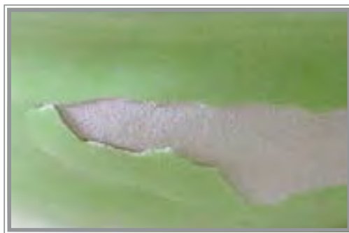
شکل ۳۲- عیب پوسته شدن لعاب
