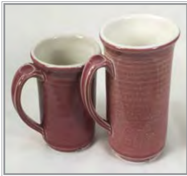
شکل ۳۰- لعاب با دمای پخت نامناسب
