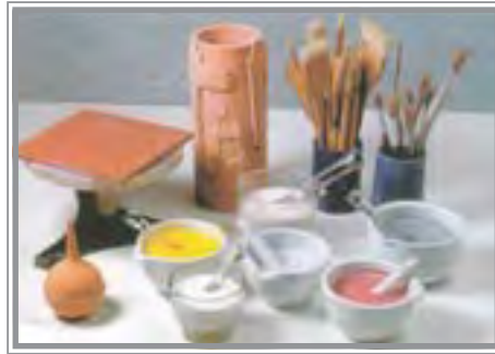
شکل ۱۴- تجهیزات مورد استفاده جهت لعاب‌زنی با قلم‌مو
