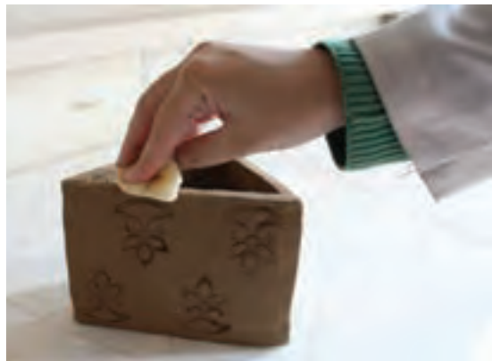
الف) پرداخت قطعات شکل‌دهی دستی با استفاده از اسفنج نرم ب) اجرای پرداخت قطعات شکل‌دهی دستی با چاقوی پرداخت
