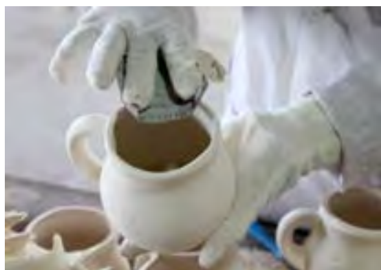
شکل ۱۱- پرداخت خشک قطعه شکل‌دهی شده با اسکاچ و سنباده
