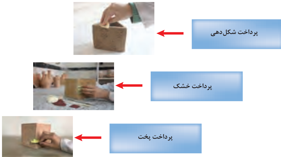
شکل ۸- مراحل پرداخت فرآورده‌های سرامیکی
