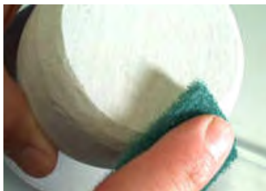
شکل ۱۱- پرداخت خشک قطعه شکل‌دهی شده با اسکاچ و سنباده
