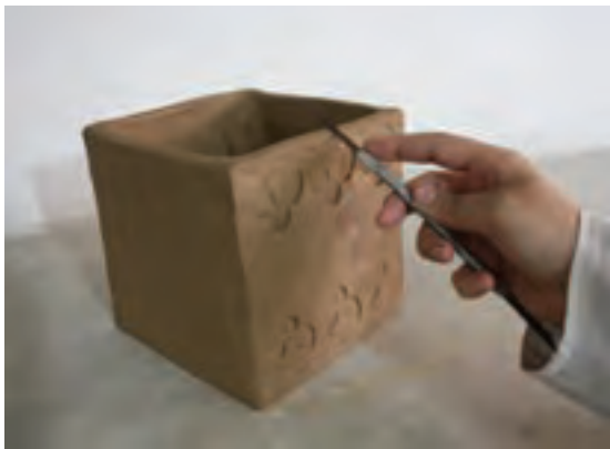
الف) پرداخت قطعات شکل‌دهی دستی با استفاده از اسفنج نرم ب) اجرای پرداخت قطعات شکل‌دهی دستی با چاقوی پرداخت
