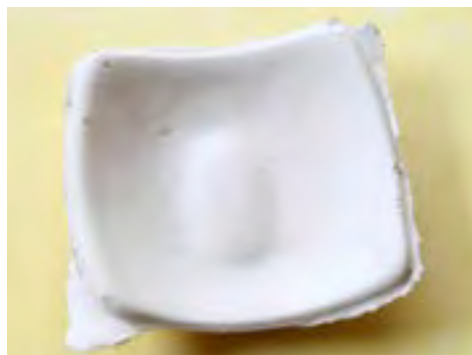
شکل ۱۰- قطعه سرامیکی دارای اضافات
