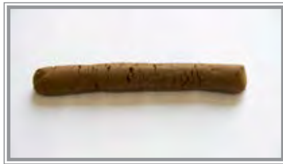
گل با شکل‌پذیری نامناسب - دارای ترک
