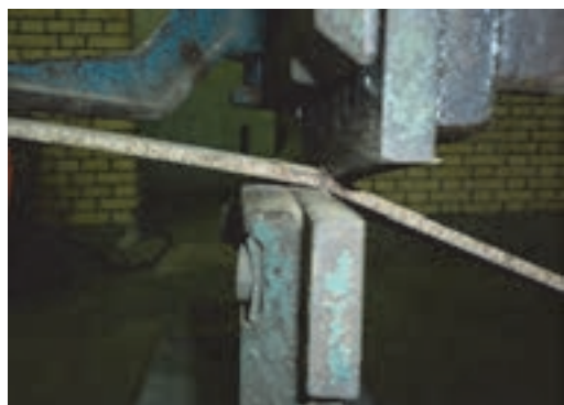
شکل ۲۹- نفوذ تیغه‌ها در قطعه
