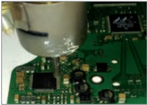
شکل ۲-۴ دمونتاز آی سی های چهار طرفه (خرچنگی)
