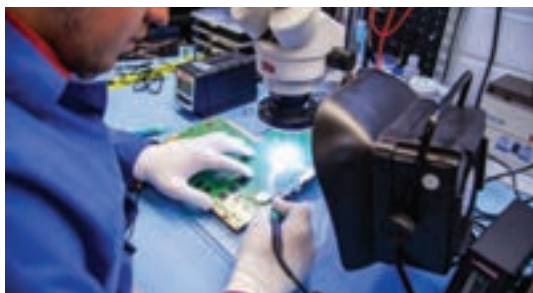
شکل ۲-۳ مونتاژ دستی بردهای الکترونیکی
