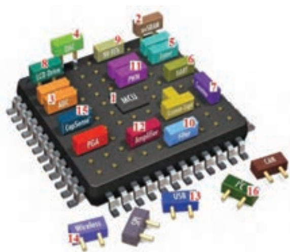
ب) ساختار داخلی میکروکنترلر ARM
