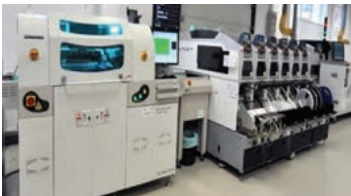
شکل ۱۱-۳ دستگاه تمام خودکار مونتاژ قطعات SMD
