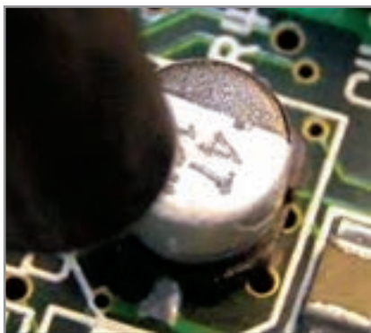
شکل ۲-۳ دمونتاز خازن سرامیکی و الکتrolیت SMD
