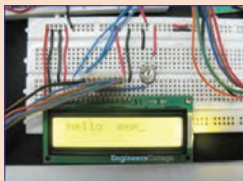
شکل ۷-۴۴ اتصال صحیح LCD و تنظیم شدت روشنایی
