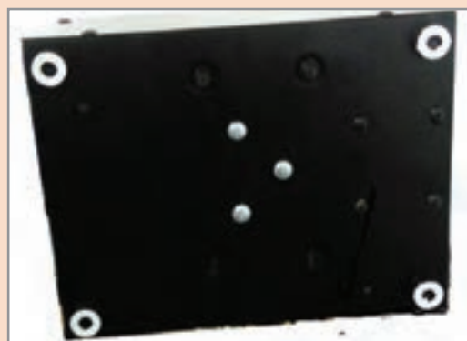
شکل ۱-۴ سه پیچ قفل کننده کمپرسور به بدنه
