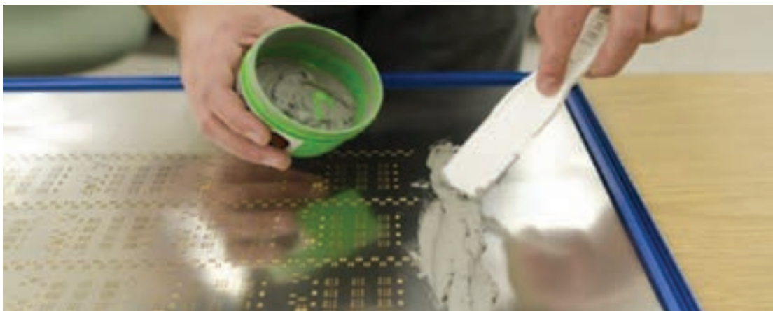
شکل ۱۲-۳ خمیر اندود کردن لحیم به کمک شابلون
