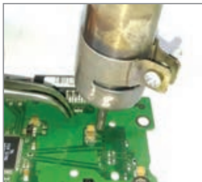
شکل ۲-۳ دمونتاز خازن سرامیکی و الکتrolیت SMD
