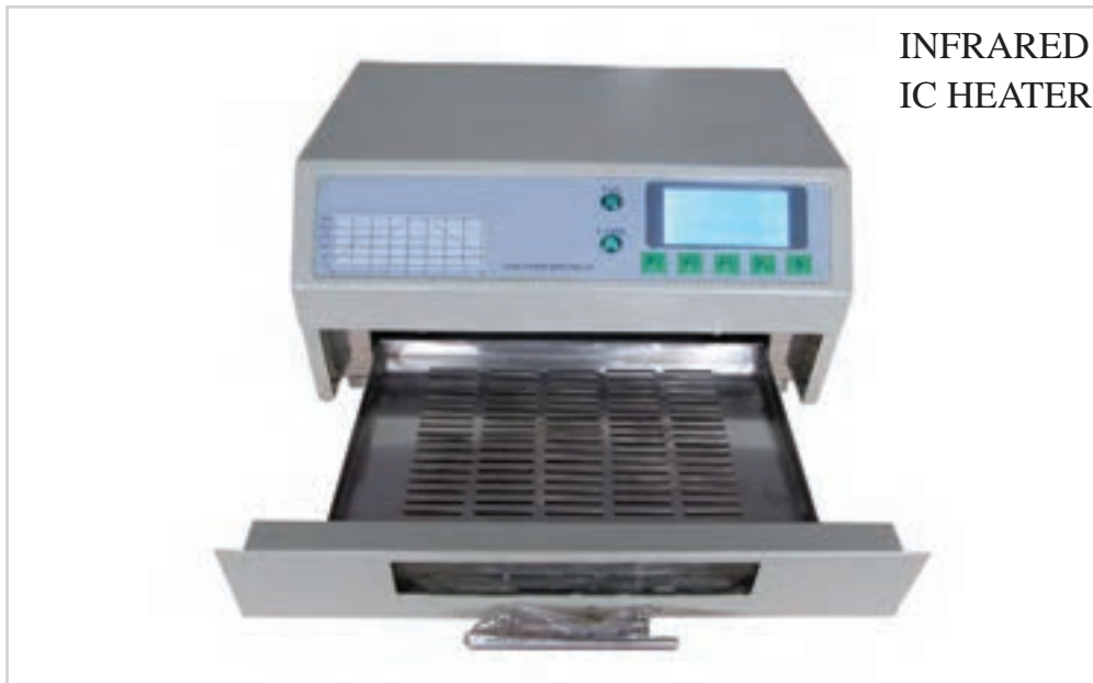
شکل ۳-۱۸ دستگاه کوره جهت ذوب کردن خمیر لحیم
