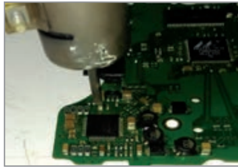
شکل ۲-۴ دمونتاز آی سی های چهار طرفه (خرچنگی)
