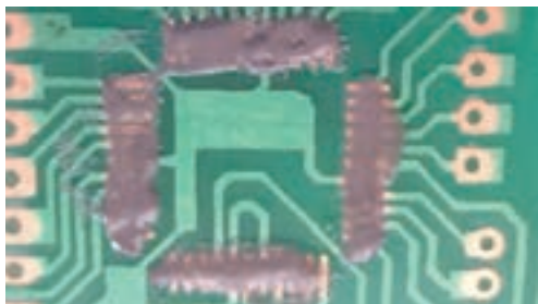
شکل ۹-۳ قرار گرفتن خمیر قلع روی تمامی پدها
