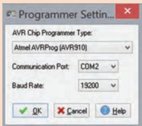
شکل ۷-۲۱ تنظیم پورت و سرعت پروگرامر AVR ۹۱۰
