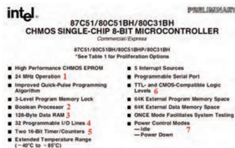
شکل ۶-۵ برگه اطلاعات میکروکنترلر ۸۰۵۱
