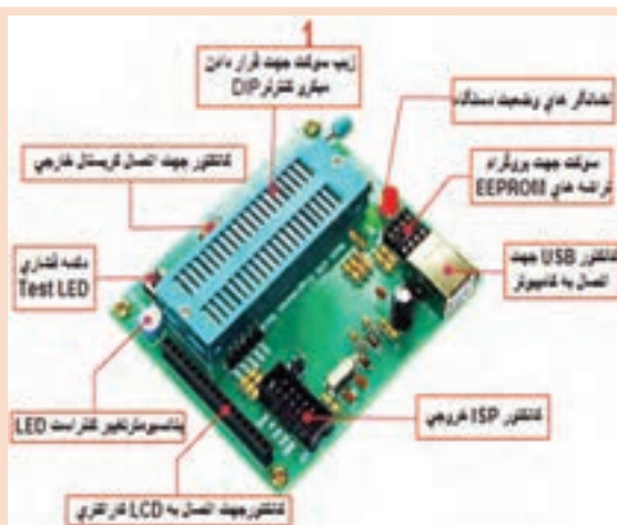
شکل ۷-۲۳ سوکت ZIP برای قراردادن میکرو
