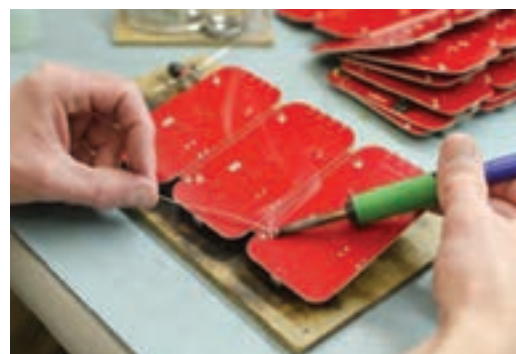
شکل ۳-۱۹ لحیم کاری دستی قطعات DIP با هویه و سیم لحیم
