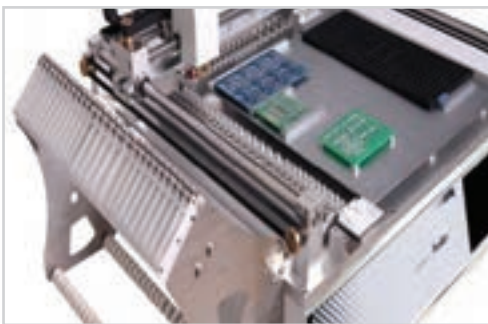
شکل ۳-۱۶ نمونه‌هایی از دستگاه Pick And Place
