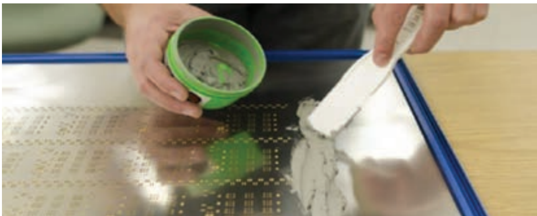
شکل ۱۲-۳ خمیر اندود کردن لحیم به کمک شابلون
