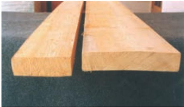
تصویر ۳-۵-۱—دو نمونه تخته استاندارد از چوب کاج
