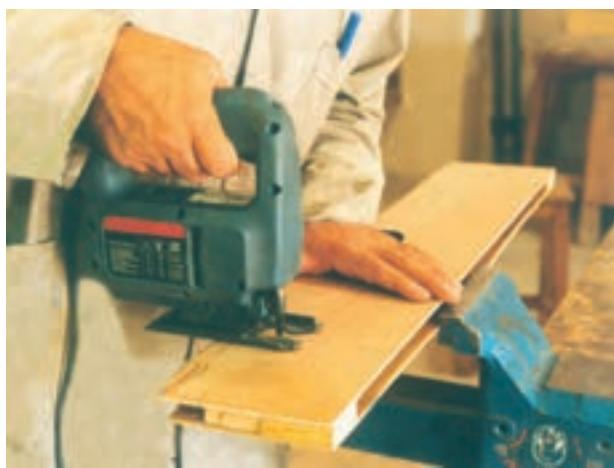
تصویر ۱-۴-۱— روش درست بکارگیری ابزارهای برقی متحرک
