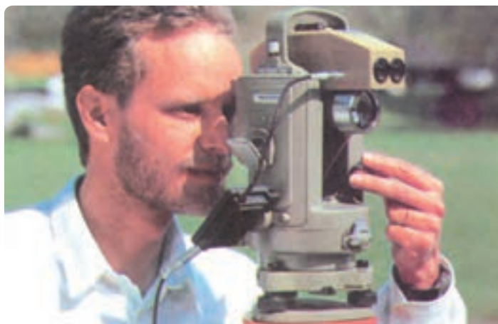
شکل ۲۳-۴ نصب فاصله‌یاب روی دوربین
