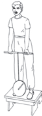
شکل ۵-۲ - دینامومتر برای اندازه‌گیری قدرت ایستا
