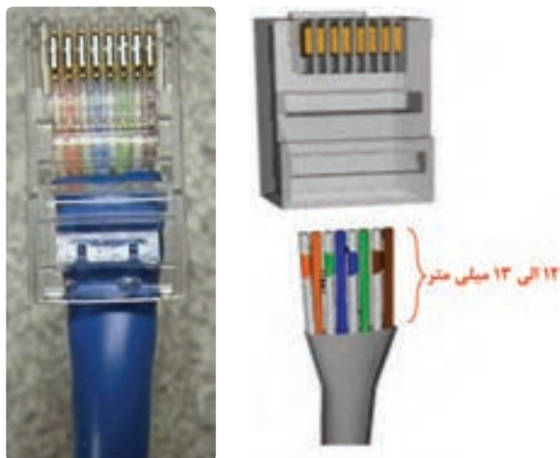
شکل ۴۶- سوکت زدن به سر کابل
