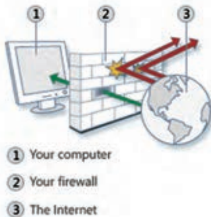
شکل ۷-۱- تصویر عملکرد دیوار آتش
