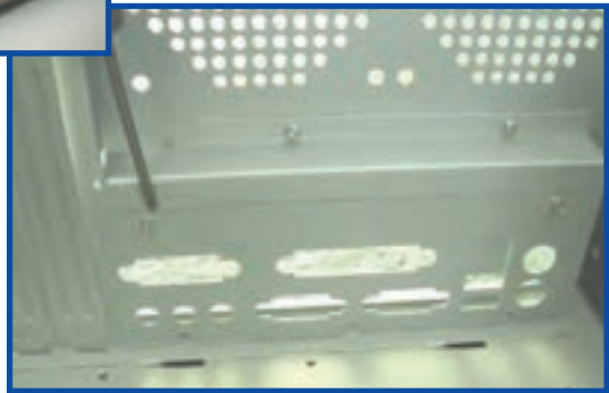
شکل ۸-۱۳ نصب پانل ورودی/خروجی
