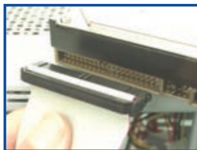
شکل ۸-۲۲ نصب کابل IDE
