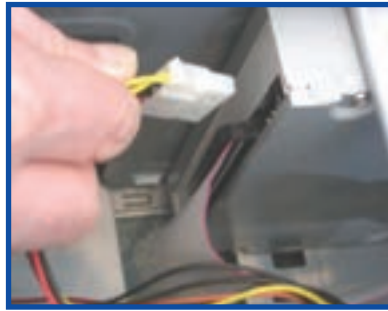
شکل ۲۳-۸ اتصال کابل برق دیسک گردان نوری
