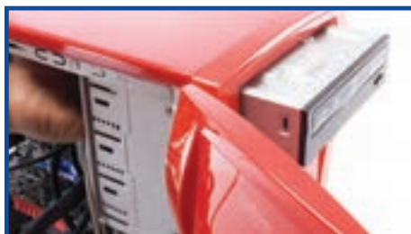
شکل ۸-۲۱ استقرار دیسک گردان نوری
