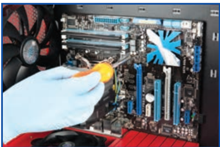
شکل ۸-۱۵ بستن پیچ‌های برد اصلی
