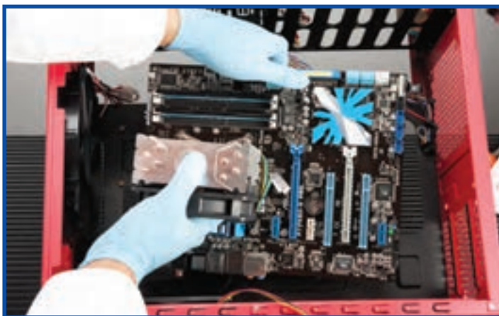
شکل ۸-۱۴ نصب برد اصلی
