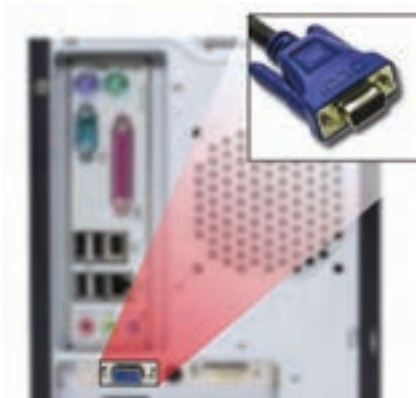
شکل ۱۵-۵ درگاه خروجی ۱۵ پین VGA برای اتصال به صفحه‌نمایش‌های آنالوگ
