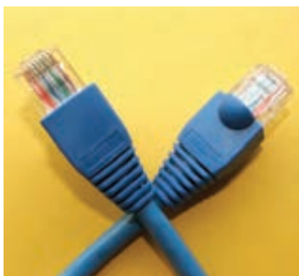
شکل ۳۵-۵ اتصال دهنده کابل شبکه در پشت کیس و سر کابل آن
