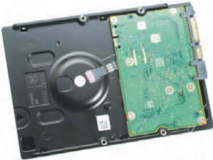
شکل ۴-۴۳ برد مدار چاپی روی دیسک سخت. کنترلر روی این برد وظیفه تبدیل داده‌های خوانده شده به داده‌های قابل فهم برای رایانه را دارد.
