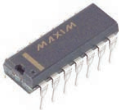
شکل ۹-۴ نوعی حافظه DIP که روی برد اصلی لحیم می‌شدند.
