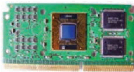
شکل ۳-۳۱ جلو و پشت پردازنده پنتیوم II با دو تراشه حافظه نهان و به صورت شکاف ۱
