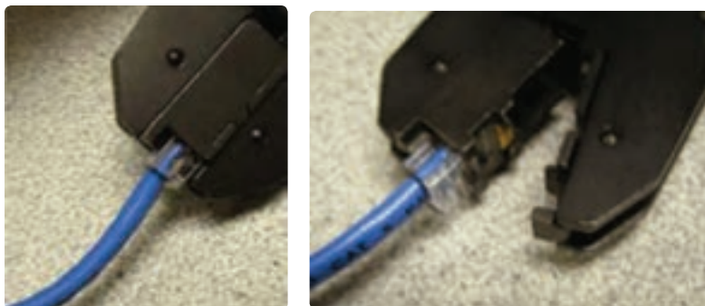
شکل ۴۷- پرس سوکت های کابل شبکه
