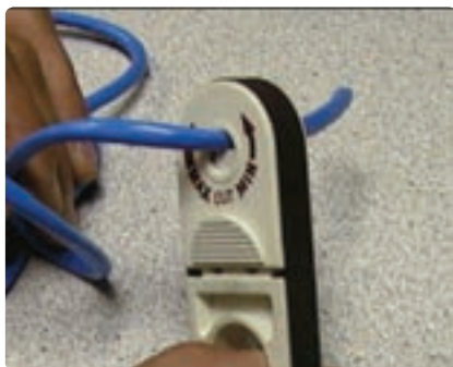
شکل ۴۴-۴- روکش برداری از کابل شبکه
