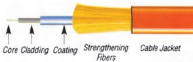
شکل ۸-۴- اجزای تشکیل‌دهنده یک کابل فیبر
