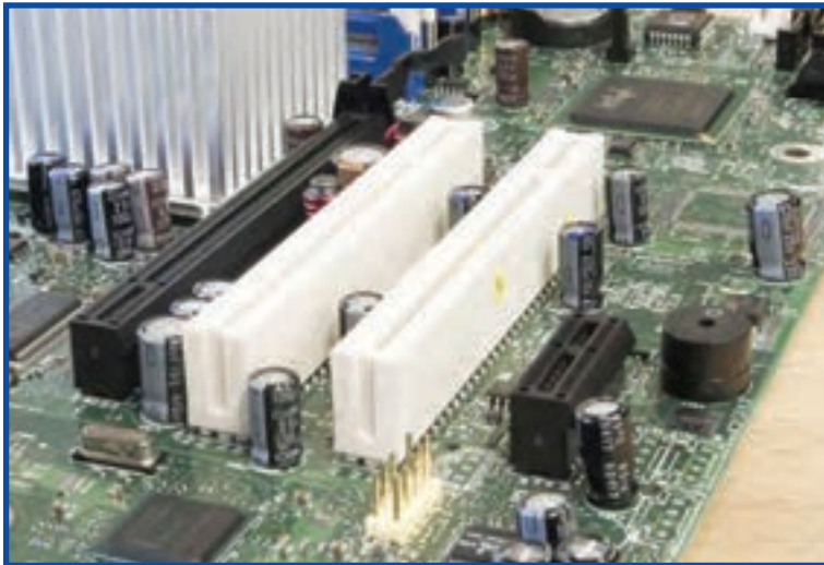
شکل ۲۷-۲ دو شکاف توسعه PCI به رنگ سفید و دو شکاف توسعه PCI-E به رنگ مشکی که سمت چپ 16x و سمت راست 1x هستند.
