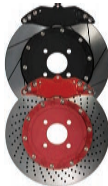
شکل ۷-۳۲ ترمز دیسکی خودرو
