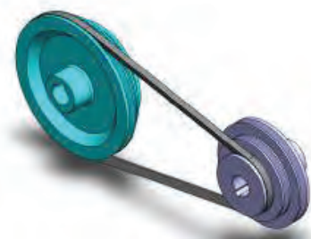
(ب) مکانیزم چرخ تسمه
