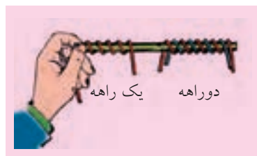
(ب) تشکیل پیچ یک‌راهه و دوراهه
