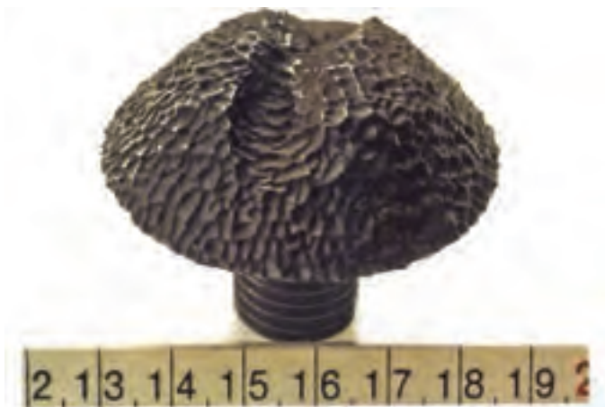
شکل ۲۲-۷- پیچ در محلول خورنده حاوی ذرات ساینده دچار خوردگی فرسایشی شده است.
