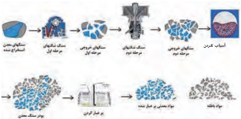
شکل ۲-۲- روند عمومی استخراج و برعیارسازی سنگ‌های معدنی
