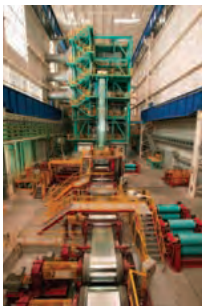
شکل ۸-۶. خط گالوانیزه کردن ورق و قوطی‌های فولادی
