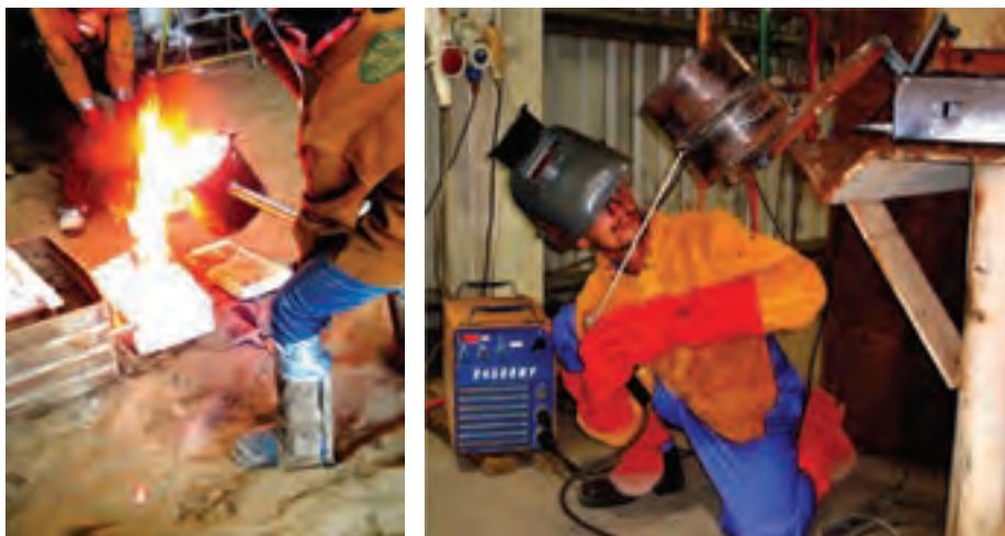
شکل ۳-۱۴ ذوب ریزی درون قالب ریخته گری
