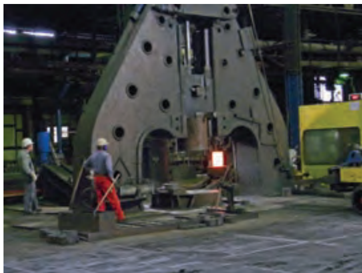
شکل ۸-۱۷- تولید قطعات فولادی به روش آهنگری در یک واحد بزرگ صنعتی
