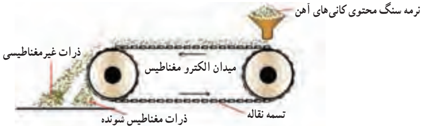
شکل ۲-۵- جداسازی کانی‌های فرومغناطیس آهن از مواد باطله
