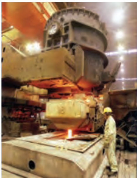
شکل ۱۴-۸- عملیات ذوب‌ریزی از پاتیل حمل مذاب
