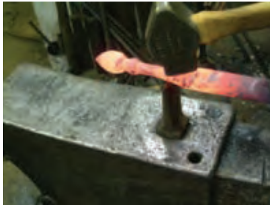
شکل ۸-۱۵- آهنگری به روش سنتی
