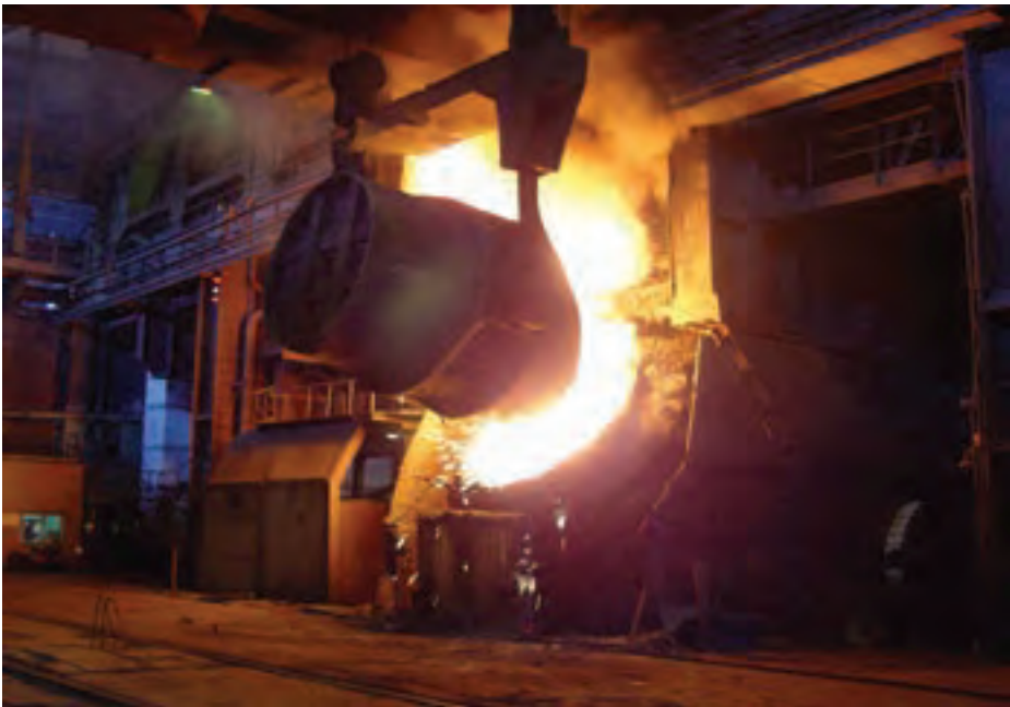
شکل ۴-۷- اضافه کردن عناصر آلیاژ به کوره فولادسازی
