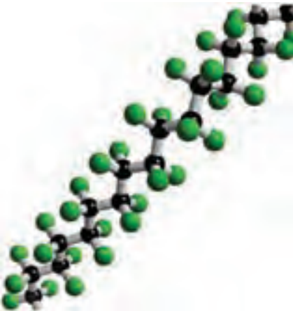
شکل ۱-۵- بخشی از یک مولکول پلیمری (تفلون)
