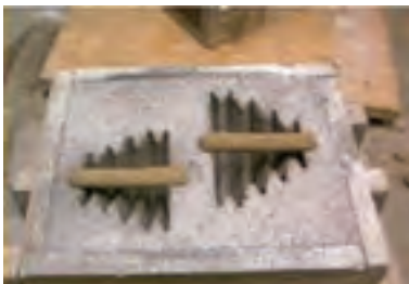
شکل ۵-۸- ماهیچه گذاری در قالب ریخته‌گری
