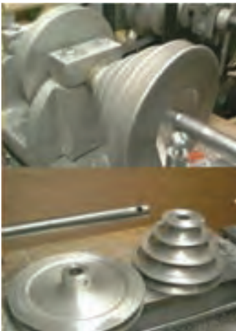
شکل ۷-۸- پرداخت کاری سطحی
