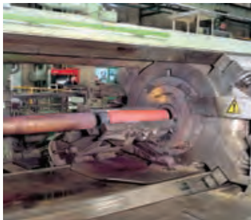
شکل ۲۶-۸- اعمال فشار توسط پرس هیدرولیک به فلز گداخته در فرآیند اکستروژن
