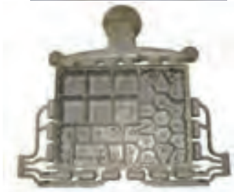
شکل ۱۰-۸- چند نمونه از قطعات ریخته‌گری شده به روش دایکاست پیوسته
