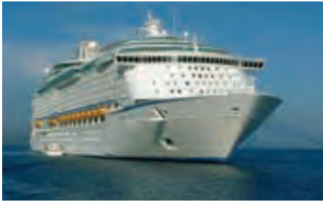
شکل ۹-۲- کشتی مسافربری ساخته شده از آلیاژهای آلومینیومی
