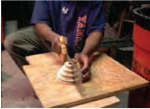
شکل ۲-۸- تهیه مدل ریخته‌گری ماسه‌ای
