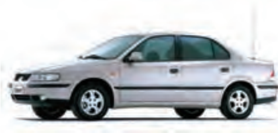
شکل ۹-۴- بدنه خودرو به‌طور معمول از فولادهای میکروآلیاژی (کم آلیاژ) ساخته می‌شود.
