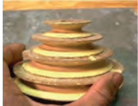
شکل ۲-۸- تهیه مدل ریخته‌گری ماسه‌ای
