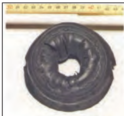
شکل ۶-۷- قطعه پلاستیکی در معرض محلول شیمیایی دچار تورم و تخریب شده است.
