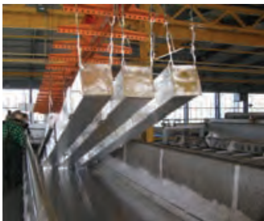
شکل ۸-۶. خط گالوانیزه کردن ورق و قوطی‌های فولادی
